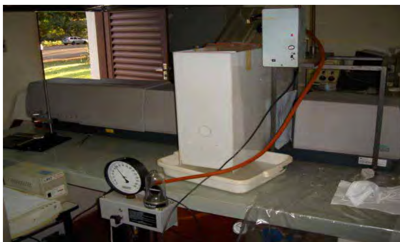
Figura 2. Laser modelo Mastersizer medidor do tamanho de gotas, Jaboticabal, SP, 2011.
