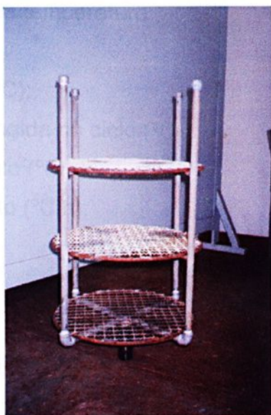
Figura 4.2: Tubulação Interna do Aparelho de Cura Térmica
