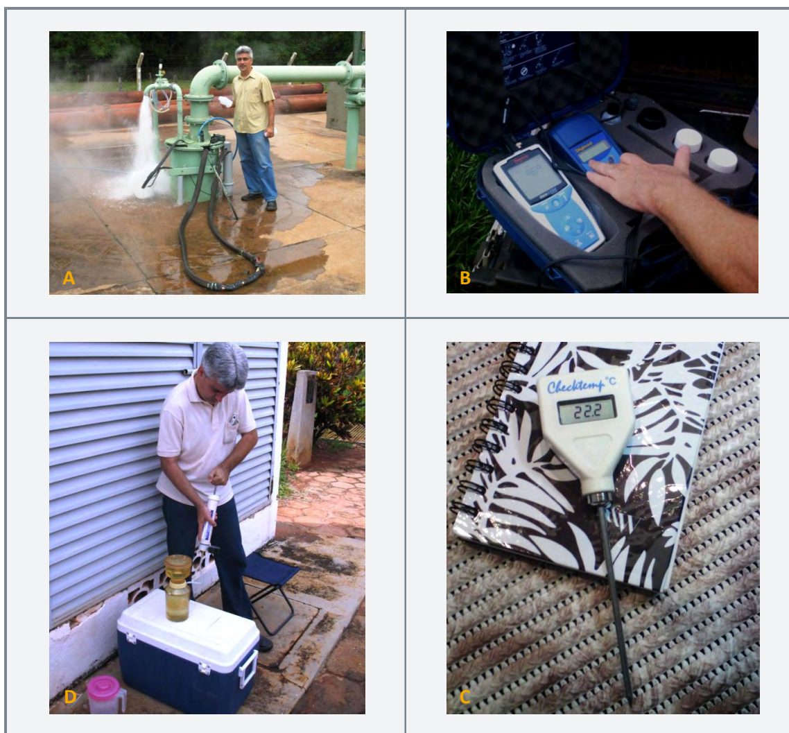
Figura 3 - Etapas da coleta e preparação das amostras. (A) Amostragem no cavalete de um poço, (B) Tomada de condutividade e pH, (C) Termômetro utilizado, (D) Filtragem de amostra
