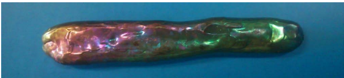
Figura 2 – Lingote obtido após fusão e sequência de tratamentos térmicos
