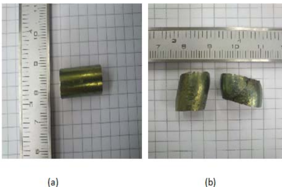
Figura 3 – (a) corpo de prova antes e (b) após realização do ensaio de compressão
