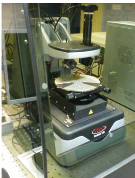
Figura 3.5.1: Fotografia do Perfilômetro Veeco Dektak 150
