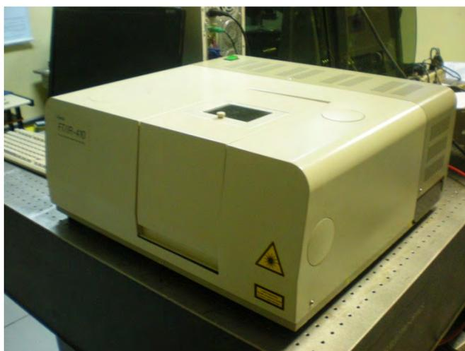
Figura 3.6.1 – Fotografia do Espectrômetro de transformada de Fourier FT/IR-410
