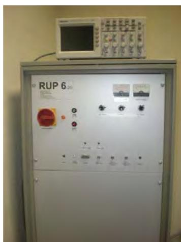
Figura 3.1.6 – Fonte geradora de pulsos de alta tensão RUP 6-20 GBS- Elektronik- GmbH
