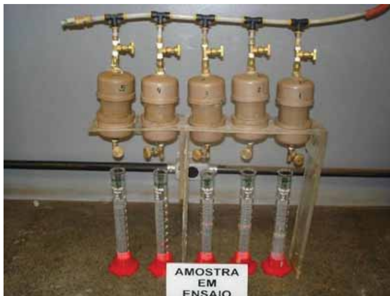
Figura 3. 24 - Percolação de água em corpos-de-prova do ensaio de resistividade elétrica. (apud BOSZCZOWSKI, 2008)
