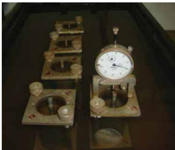
Figura 4. 13 - Foto do ensaio de mini-CBR colocado para expansão.
