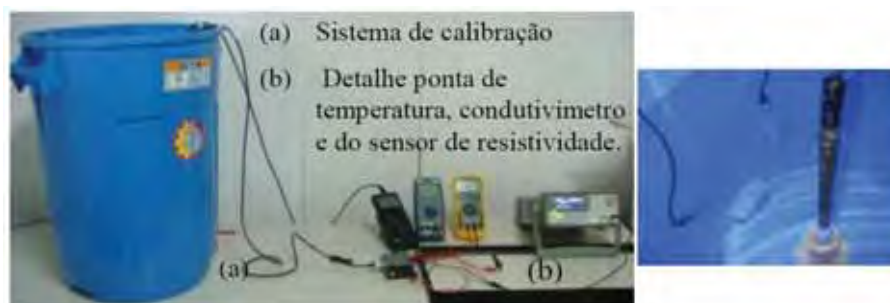
Figura 3. 14 - Sistema de Calibração do Mini-sensor de Resistividade (PREGNOLATO e PEIXOTO, 2010)
