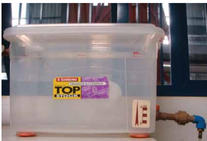
Figura 4. 39 – Foto do reservatório de água com capacidade para 38 litros.
