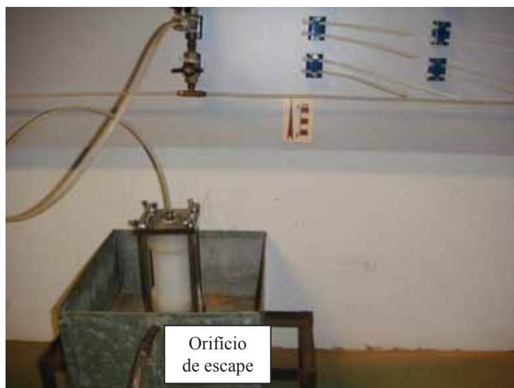
Figura 4. 44 – Detalhe do tanque inferior com orifício de escape.
