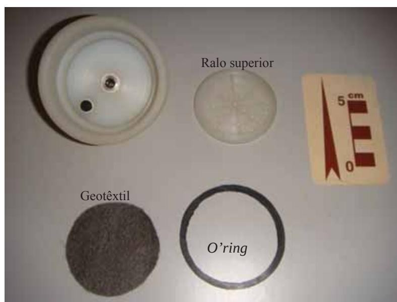
Figura 4. 29 – Detalhe da tampa e do ralo superior.
