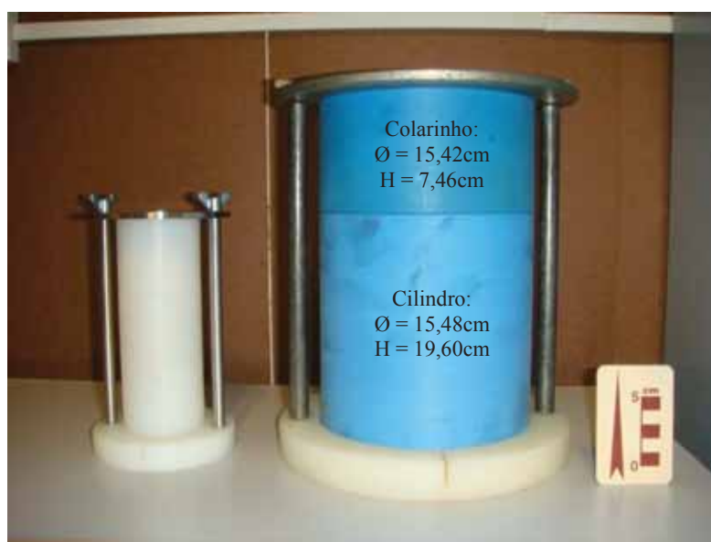
Figura 4. 27 – Mini-cilindro de compactação e modelo do cilindro grande.
