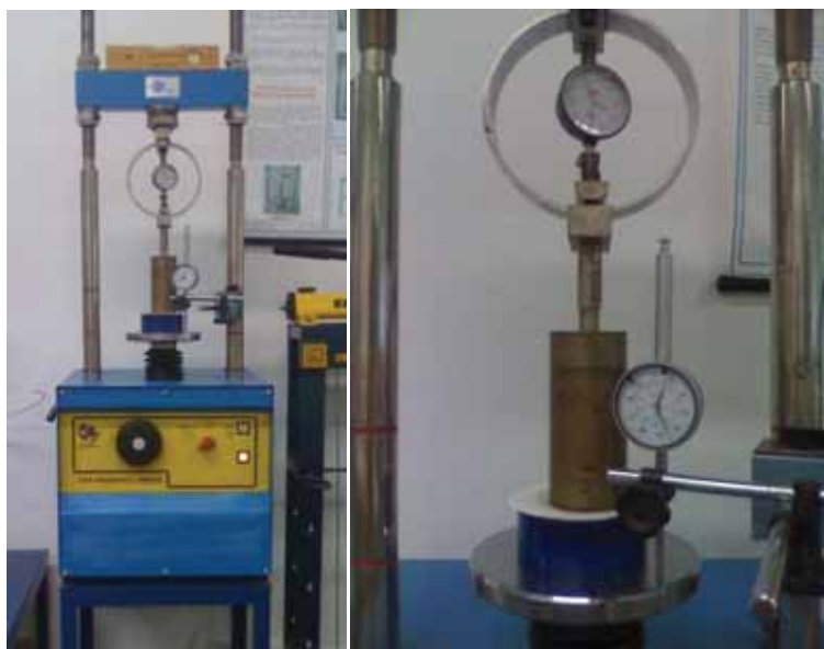
Figura 4. 11 - Fotos da montagem do equipamento de determinação da capacidade de suporte.
