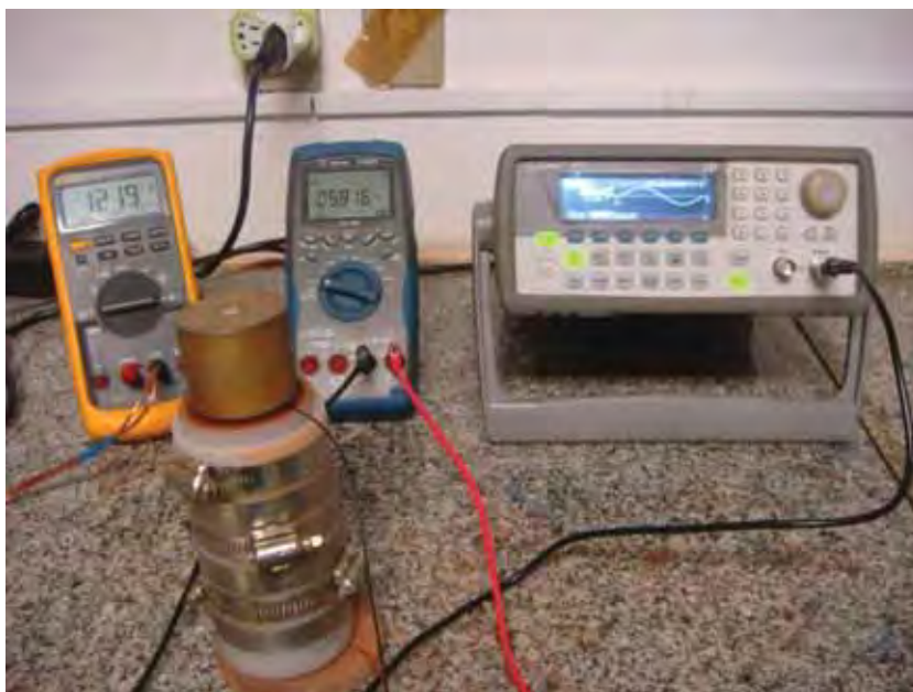
Figura 4. 43 – Ligação do cilindro ao sistema com o sobrepeso.
