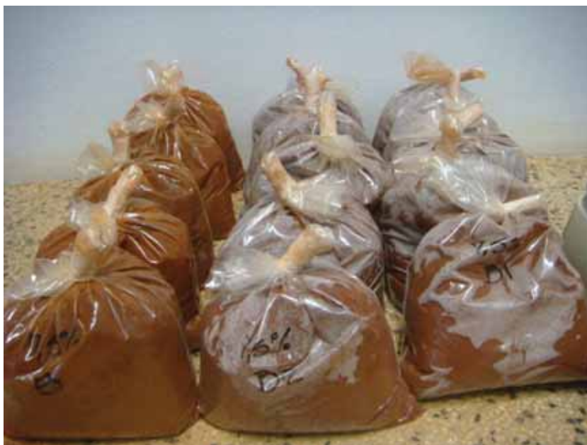
Figura 4. 41 – Foto das amostras homogeneizadas e deixadas em repouso por no mínimo 24 horas.
