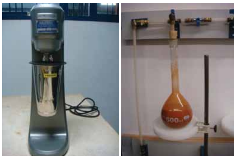
Figura 4. 5 - Dispersor de solos e balão volumétrico com a amostra de solo e água destilada.
