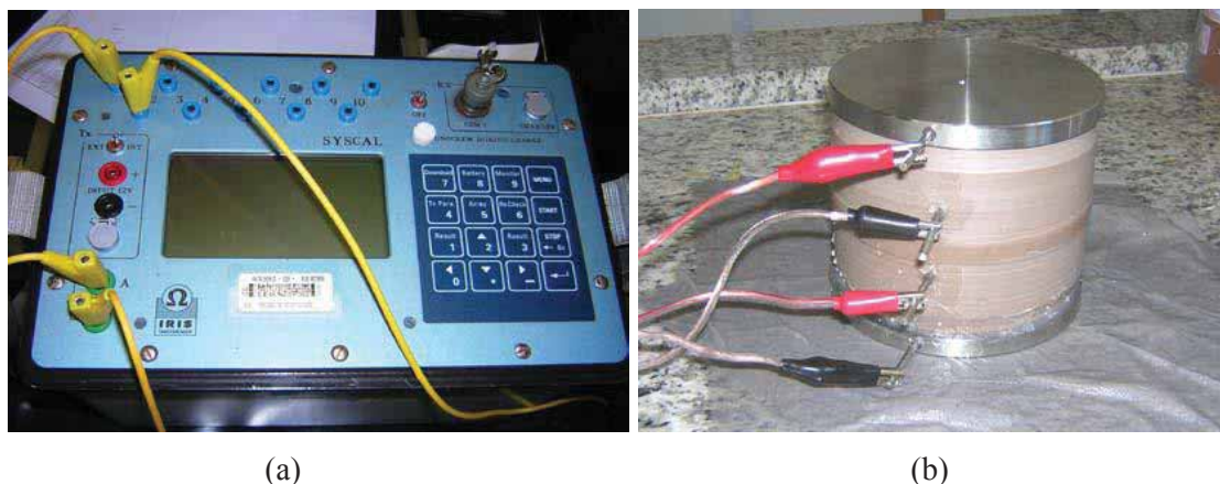
Figura 3. 39 - (a) Eletrorresistivímetro Syscal Pro utilizado por MONDELLI (2008) para obtenção de valores de resistividade em laboratório e (b) Detalhe do corpo de prova instrumentado para medida da resistividade elétrica em laboratório (MONDELLI, 2008)
