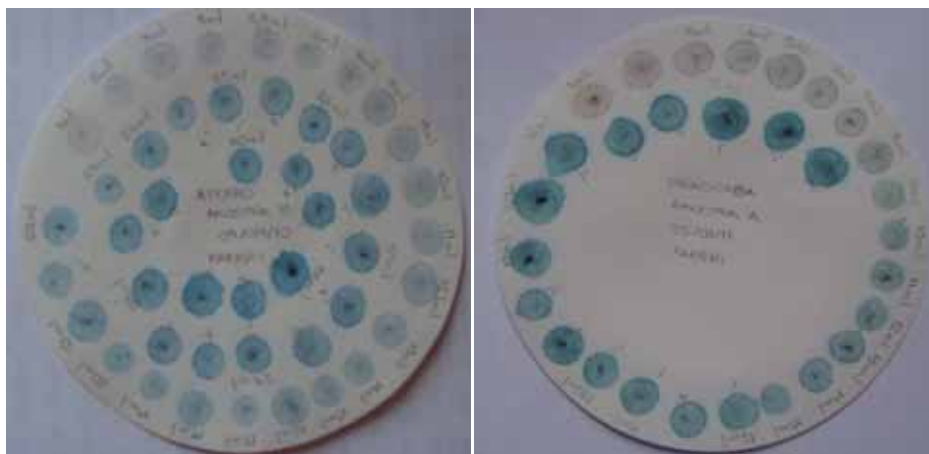
Figura 4. 24 - Foto do resultado do papel filtro com o solo Bauru e com o solo Piracicaba pelo método de Fabbri
