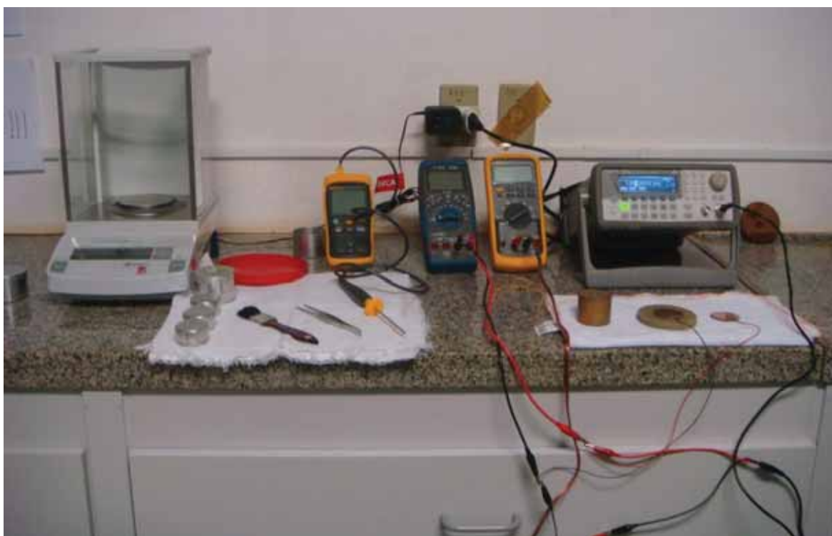
Figura 4. 52 – Estrutura montada para o ensaio de aquisição da resistividade em conjunto com a sucção matricial.
