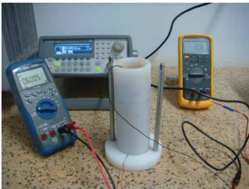
Figura 4. 42 – Montagem do circuito para aquisição das leituras de corrente e voltagem.
