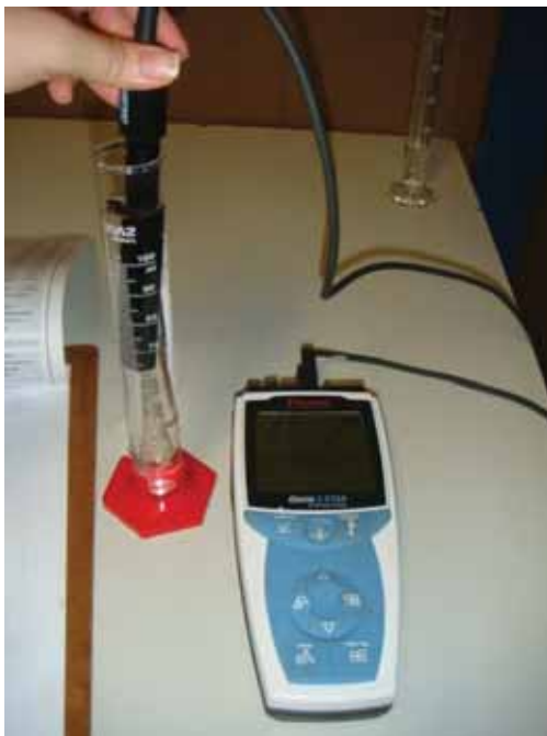
Figura 4. 40 – Verificação da condutividade do líquido com o condutivímetro da marca Thermo scientific/orion 3 star.
