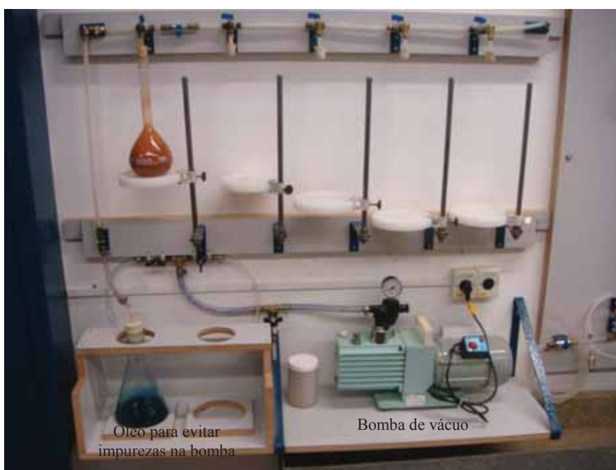
Figura 4. 6 – Sistema com a bomba de vácuo para retirada de ar da mistura de solo com água destilada.
