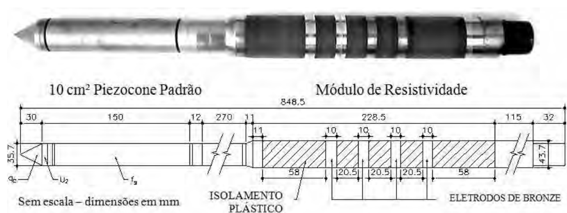
Figura 3. 1 - Esquema do Piezocone de Resistividade apud GIACHETI et al. (2006)
