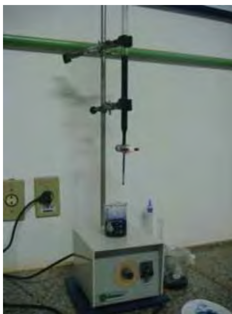
Figura 4. 20 – Foto da montagem do equipamento para ensaio de azul de metileno.
