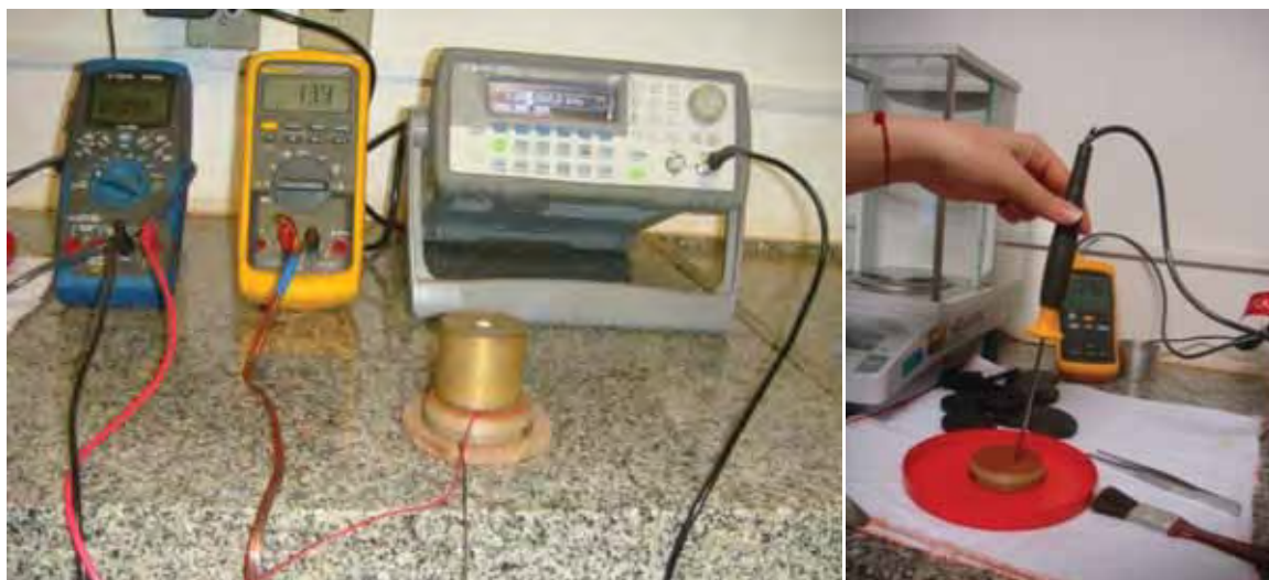
Figura 4. 53 – (a)Aquisição da corrente e voltagem e (b) medida da temperatura no corpo-de-prova.
