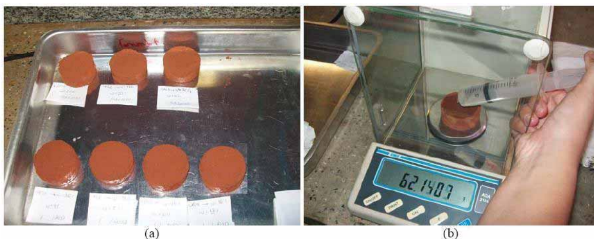
Figura 3. 36 - Preparação dos corpos de prova para ensaio de papel filtro: a) secagem ao ar, b) umedecimento por gotejamento. (AQUINO, 2010)
