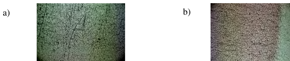
Figura 20a: Imagem obtida num microscópio óptico com aumento de 50 X do filme F1 de PANI dopada, sobre papel fotográfico. Figura 20b: Imagem obtida num microscópio óptico com aumento de 50 X do filme F5 de PANI dopada, sobre papel fotográfico
