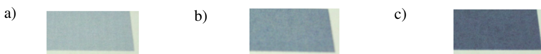
Figura 14a: Filme de PANI desdopado sobre papel fotográfico, composto por uma impressão. Figura 14b: Filme de PANI desdopado sobre papel fotográfico, composto por cinco impressões. Figura 14c: Filme de PANI desdopado sobre papel fotográfico, composto por dez impressões.
