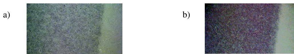
Figura 17a: Imagem obtida num microscópio óptico com aumento de 50 X do filme F1 de PANI desdopada sobre papel comum. Figura 17b: Imagem obtida num microscópio óptico com aumento de 50 X do filme F5 de PANI desdopada sobre papel comum.
