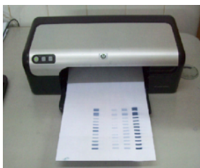
Figura 10: Foto da impressora HP Deskjet D2460, utilizada para deposição jato de tinta de PANI.
