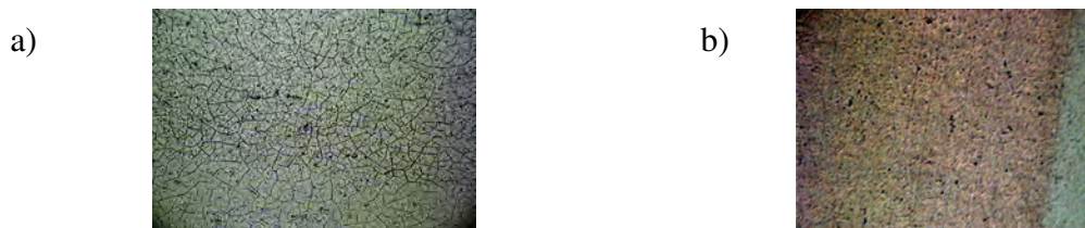
Figura 19a: Imagem obtida num microscópio óptico com aumento de 50 X do filme F1 de PANI desdopada, sobre papel fotográfico. Figura 19b: Imagem obtida num microscópio óptico com aumento de 50 X do filme F5 de PANI desdopada, sobre papel fotográfico
