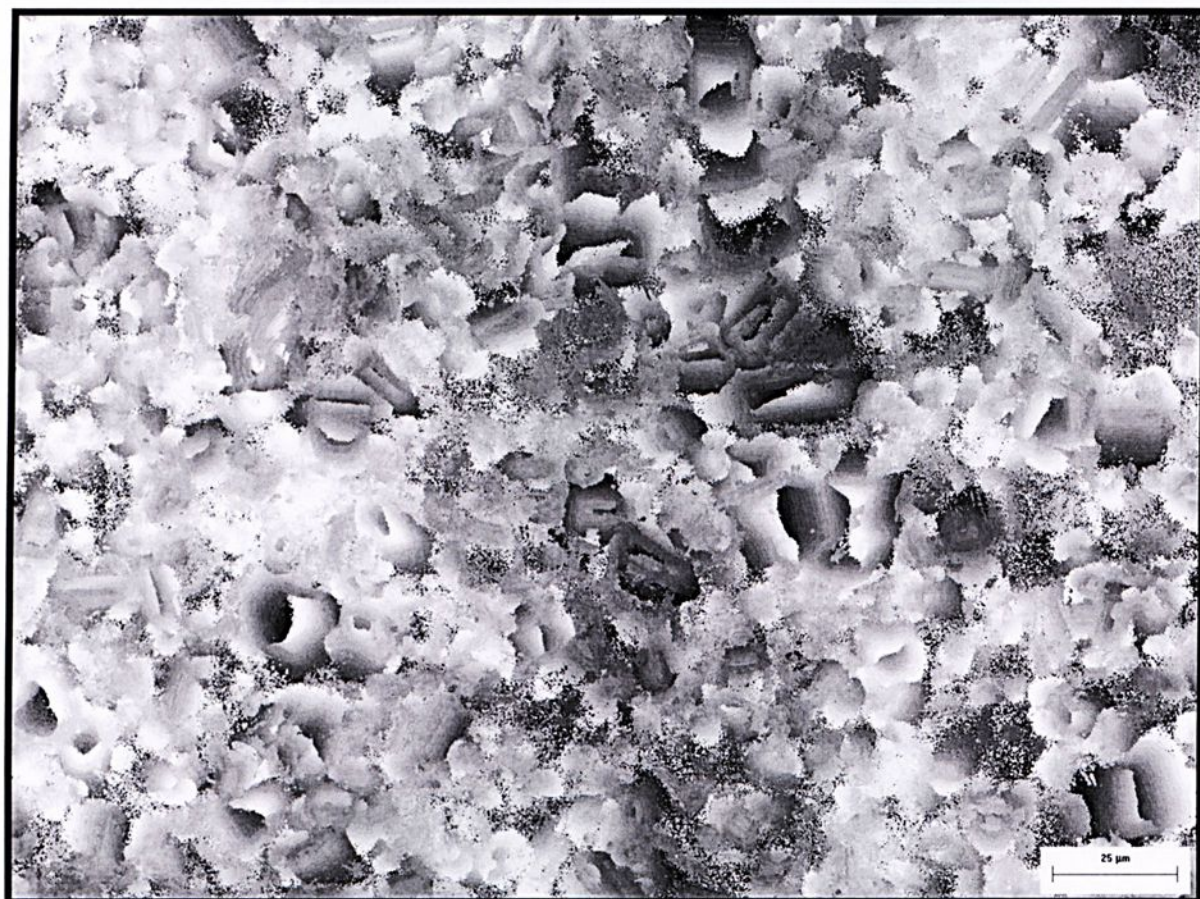
Figura 4.9 – Mapa de elevações – SiC conformado com amido
