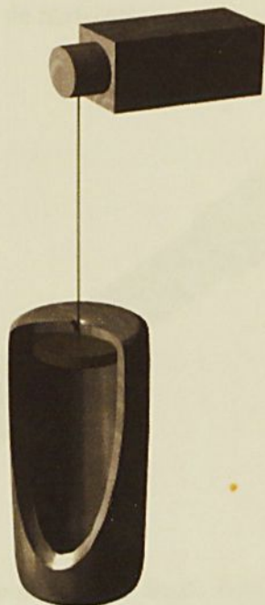
Figura 16 – Corpo-de-prova do ensaio de Pull-out
