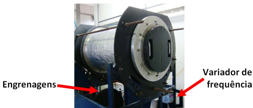
Figura 4.8. Fotografia externa do tambor rotativo e o seu sistema de suporte.
