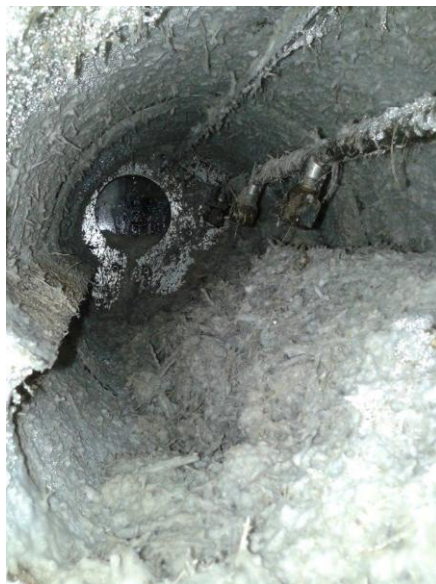
Figura 5.28. Myceliophthora thermophila I1D3b cultivado por FES após 96 horas no biorreator de aço-inox para o grau de enchimento 0,4 e com agitação do leito.
