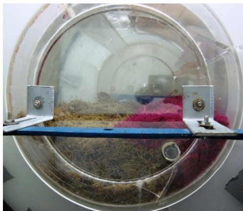
Figura 4.13. Parte frontal do tambor de acrílico no início de um experimento de mistura radial na presença de tubo interno simulador.
