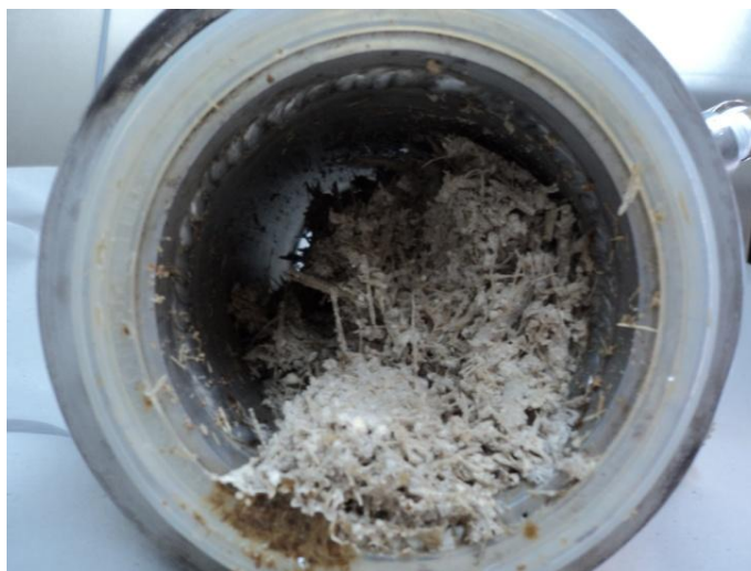
Figura 5.21. Biorreator de alumínio para o primeiro grau de enchimento após 96 horas de fermentação com uma agitação diária.
