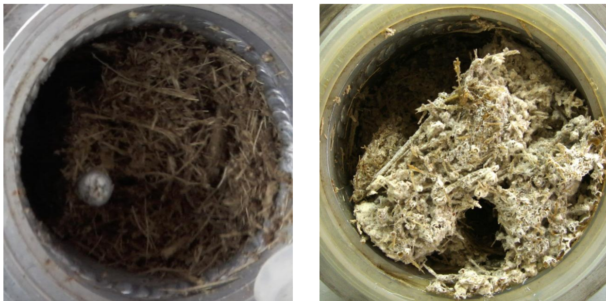
Figura 5.22. Aparência do meio de cultivo para o segundo grau de enchimento mantendo o biorreator sem agitação (a) antes do processo fermentativo e (b) após 96 horas de fermentação.
