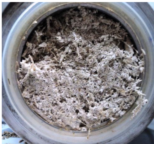
Figura 5.25. Meio fermentado após 96 horas para o terceiro grau de enchimento, com uma agitação diária.
