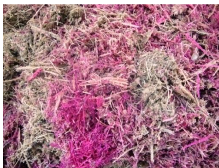
Figura 5.14. Aspecto de uma amostra de partículas ao final do processo de mistura pela técnica de traçadores coloridos em tambor com agitação interna demonstrando heterogeneidade da concentração de partículas tingidas.
