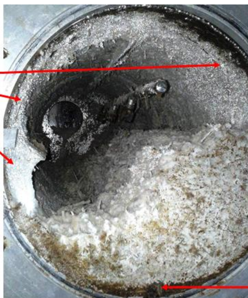
Figura 5.27. Myceliophthora thermophila I1D3b cultivado por FES após 96 horas no biorreator de aço-inox para 0,5 de grau de enchimento e sem agitação do leito.
