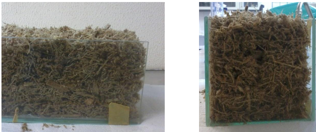
Figura 5.9. Sistema utilizado para determinar o ângulo de repouso estático da mistura bagaço-farelo (a) vista lateral e (b) vista frontal.
