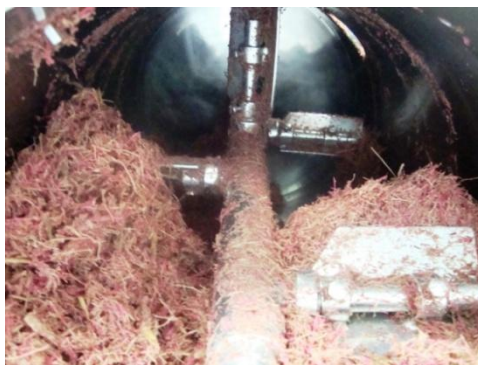
Figura 5.7. Má distribuição das partículas ao final do processo de mistura em tambor com agitação interna a través de pás.
