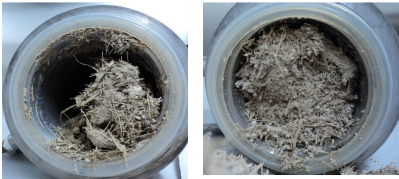
Figura 5.23. Material fermentado após 96 horas com duas agitações diárias para o segundo grau de enchimento (a) vista frontal e (b) vista traseira.
