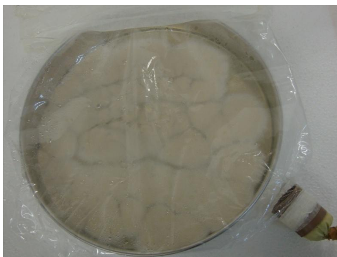
Figura 4.25. Pré-inóculo preparado em fôrmas de alumínio.
