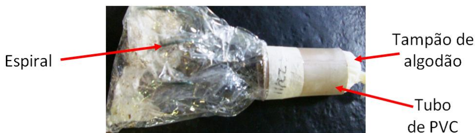
Figura 4.23. Sistema de fermentação em saco de polipropileno.
