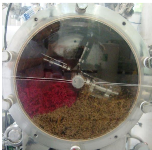
Figura 4.15. Tampa frontal do tambor com agitação interna no início de um experimento de mistura radial.
