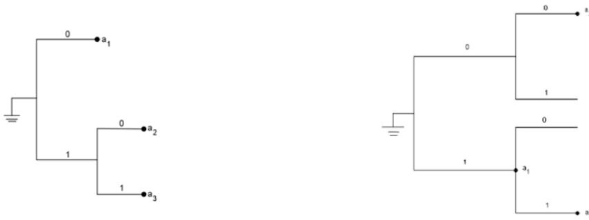
Figura 2.9: a) Árvore binária livre de prefixo do Exemplo 2.9; b) Árvore binária que não é livre de prefixo do Exemplo 2.10.
