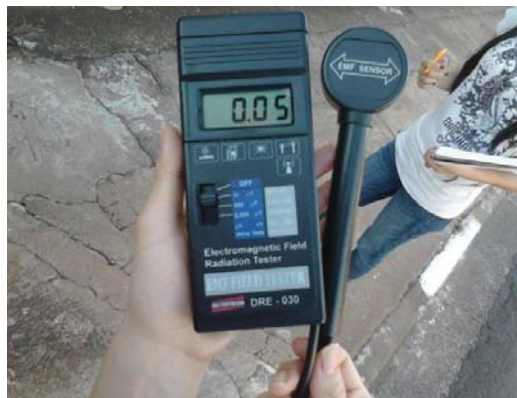
Figura 9 – Medidor de Campo Eletromagnético Digital – DRE-030, da Instrutherm
