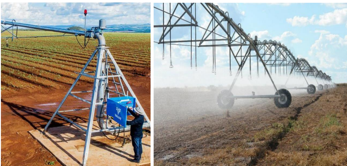
Figura 27 – a) Ponto do pivô e torre central; b) Aspersores do pivô em funcionamento.
