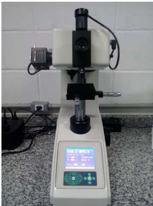
Figura 63 – Microdurômetro utilizado no ensaio de microdureza Vickers.
