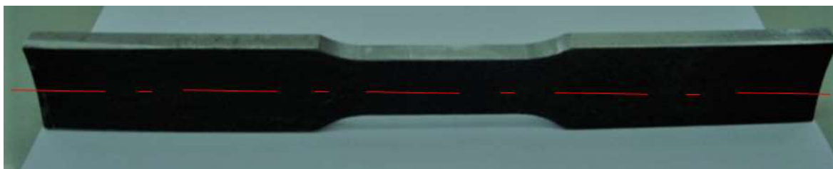
Figura 43 – Corpo de prova de tração, no formato de “meia cana”, retirado diretamente da parede do tubo.
