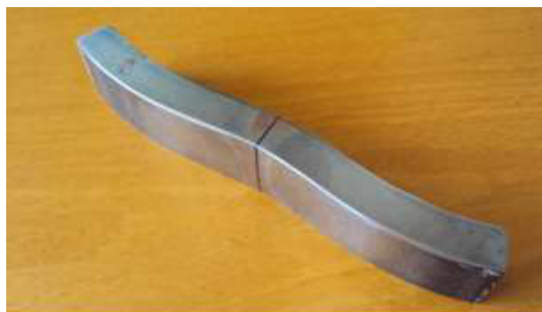
Figura 48 - Corpo de prova com linha de solda revelada e marcada.
