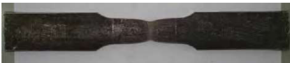
Figura 65 – Corpo de prova após realização de ensaio de tração.
