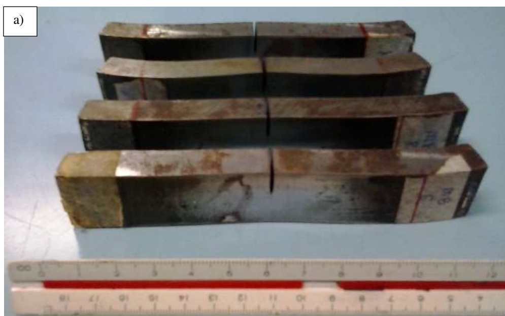
Figura 49 – Grupos de amostras entalhadas. a) Sem knife edge embutido; b) Com knife edge embutido.
