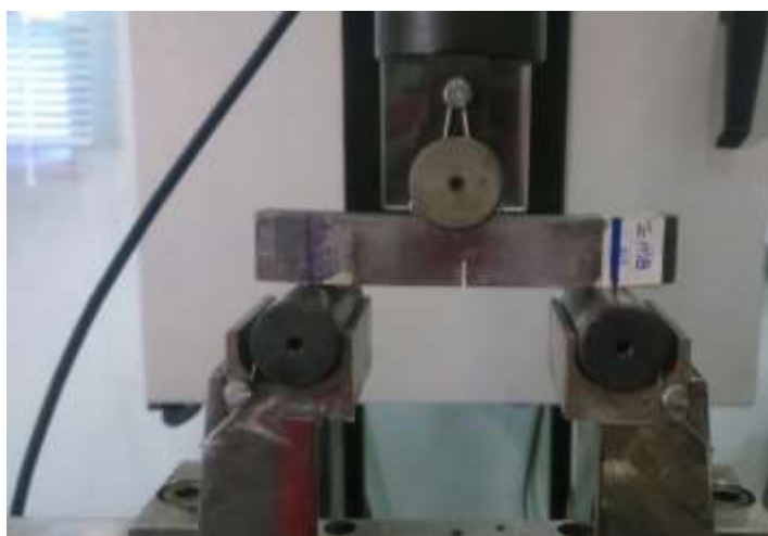
Figura 52 – Corpo de prova submetido a ensaio de pré-trinca de fadiga.
