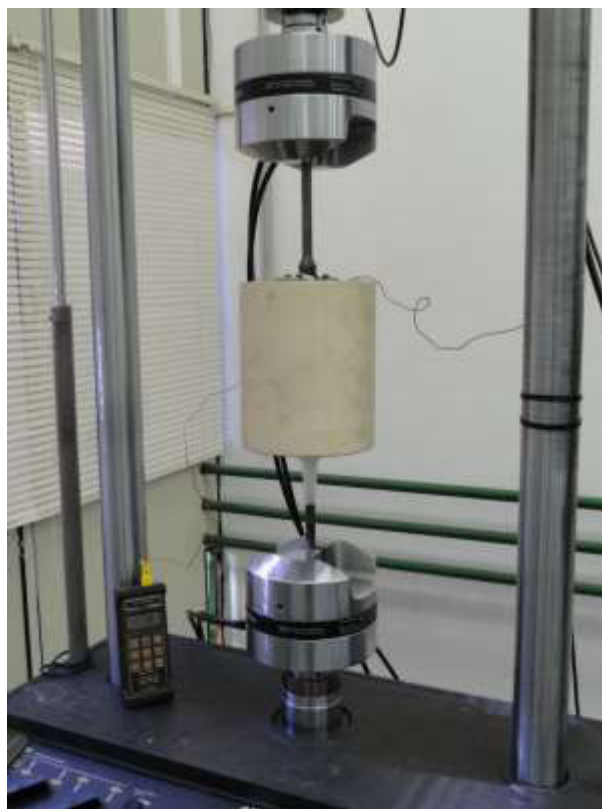
Figura 57 - Visão geral do equipamento com a caixa de aço inoxidável durante ensaio CTOD à temperatura negativa.
