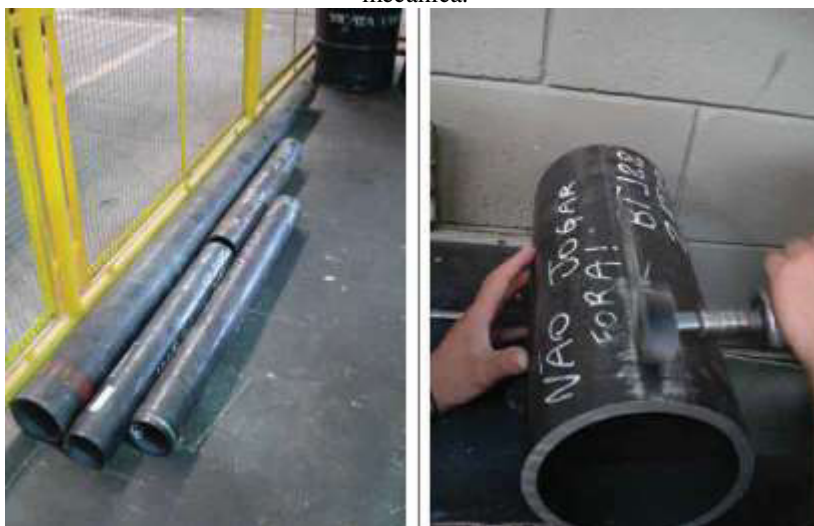
Figura 41 – Tubos utilizados para a retirada dos espécimes, para posteriores caracterizações microestrutural e mecânica.
