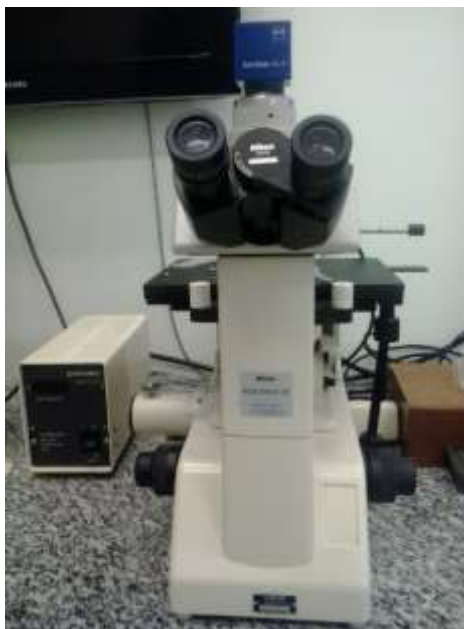
Figura 59 – Microscópio óptico utilizado para caracterização microestrutural das amostras.
