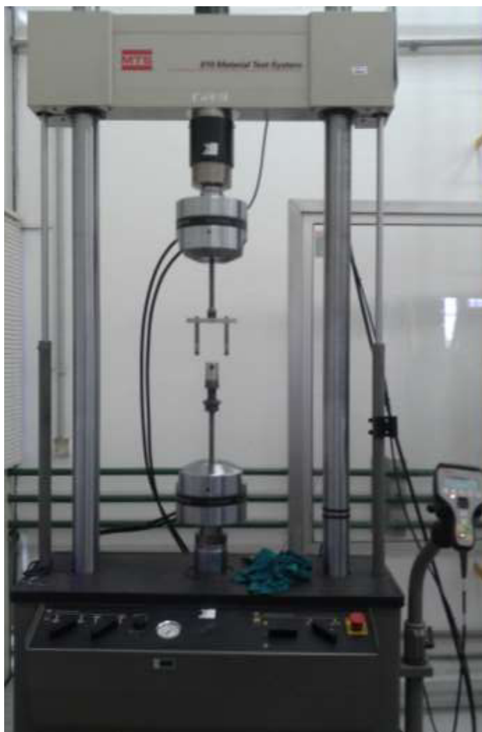
Figura 54 – Máquina utilizada neste trabalho para realização dos ensaios CTOD.
