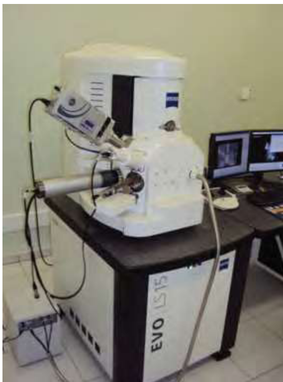
Figura 64 – Microscópio eletrônico de varredura utilizado nas análises fractográficas.
