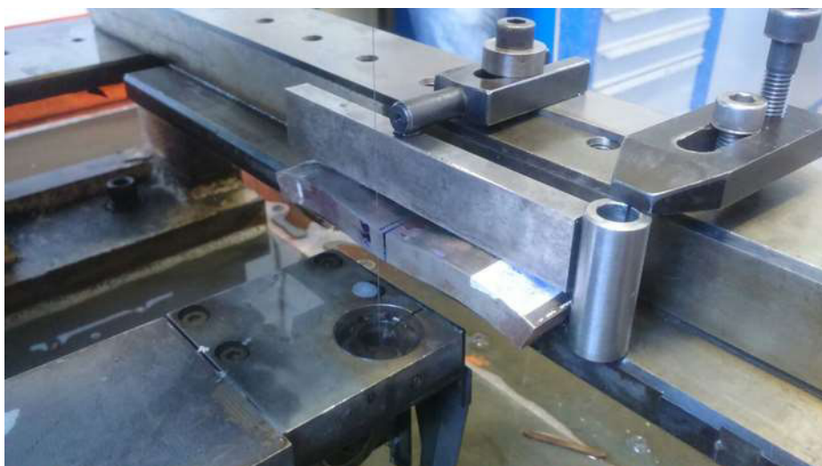
Figura 47 – Entalhamento por eletroerosão a fio.
