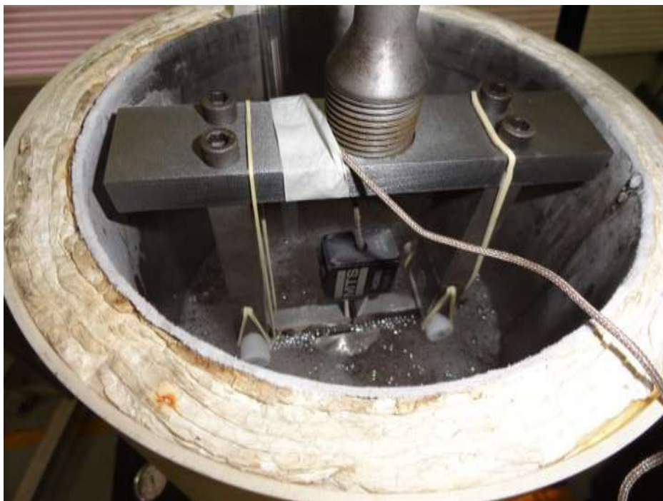
Figura 56 - Dispositivo de flexão por três pontos e corpo de prova SE(B) gull wing imersos em banho de álcool e gelo seco.
