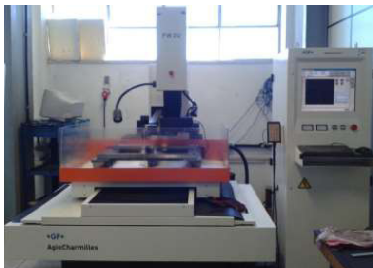
Figura 46 – Máquina de eletroerosão a fio utilizada no entalhamento dos corpos de prova.
