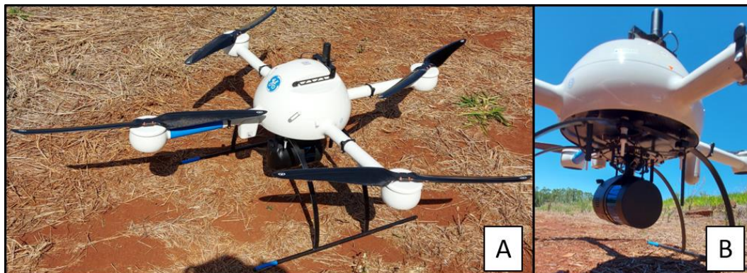
Figura 5 - A) Drone industrial de asas rotativas quadricoptero (modelo md4-1000); B) Sensor LiDAR mdLiDAR1000LR embarcado em drones
