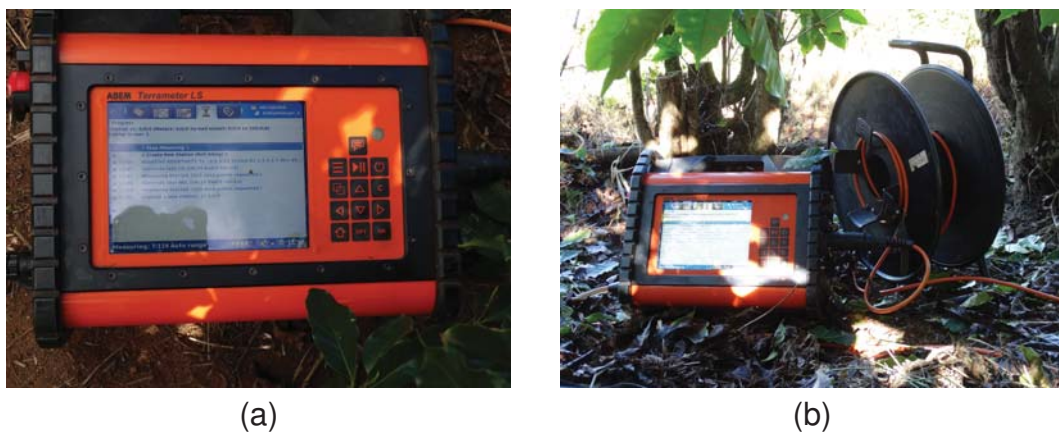
Figura 5.8: Resistímetro ABEM Terrameter LS . (a) Detalhe da interface do aparelho. (b) Detalhe do cabo acoplado.
