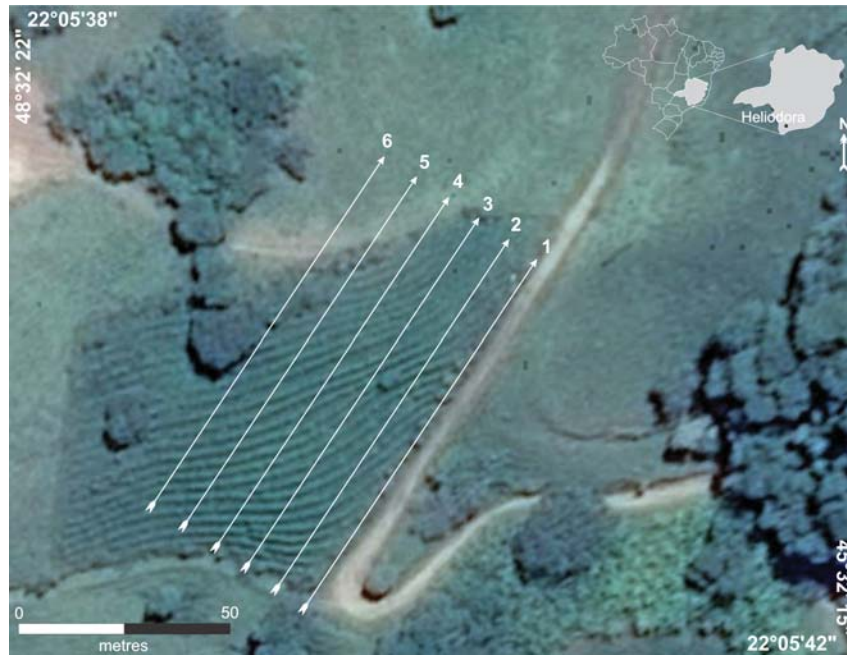
Figura 5.7: Posicionamento das linhas de aquisição de dados geofísicos.
