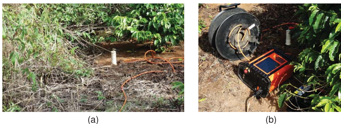
Figura 5.9: Equipamentos utilizados na aquisição dos dados geofísicos. (a) Eletrodo não polarizável. (b) Resistivímetro, bobina com o cabo, eletrodo, e bateria.
