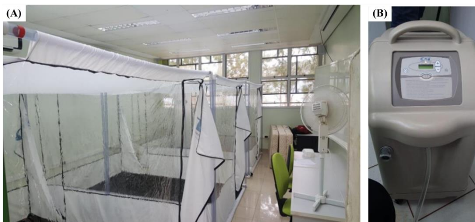
Foto 1. Registro da sala da Escola de Educação Física e Esporte de Ribeirão Preto – USP que foi adequada especificamente para alocação das tendas (a) e o gerador de hipóxia (b) para realização do presente experimento.
