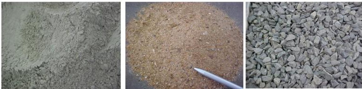
Figura 1 – Materiais Básicos do Concreto.
