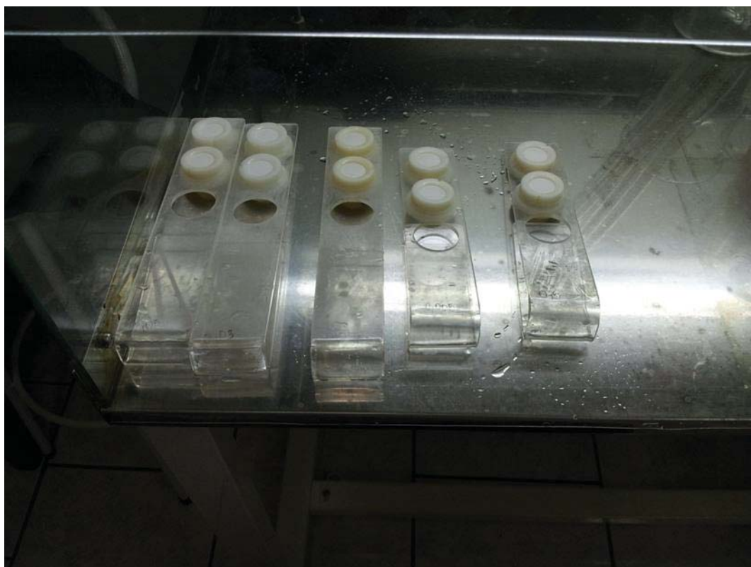
Figura 9. Dispositivos DGTs montados e prontos para imersão (Fonte: Autor, 2012).
