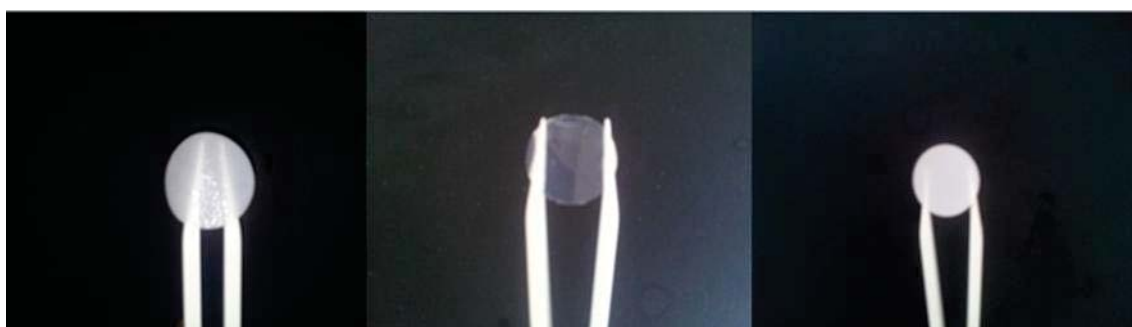
Figura 8. Da esquerda para a direita: Membrana DE 81, Agarose 1,5% (m/v) depois de seccionados, Membrana Filtro – acetato de celulose (Fonte: Autor, 2012).
