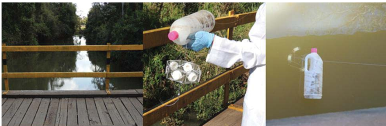
Figura 11. Da esquerda para direita: Local da imersão dos DGTs, DGTs montados na armação hexagonal, DGTs imersos em campo. (Fonte: Autor, 2012).
