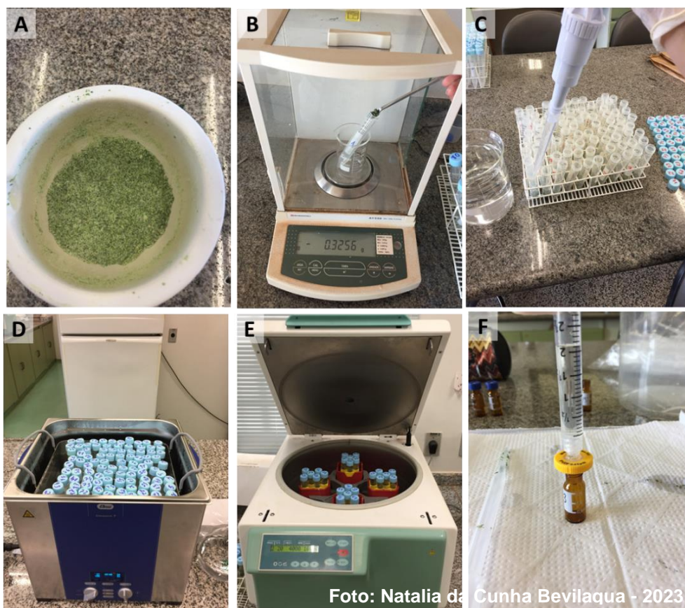
Figura 3 - Procedimentos para determinação do teor interno dos compostos. Maceração (A), pesagem (B), adição da solução extratora (C), sonicação (D), centrifugação (E) e filtragem (F) das amostras.
