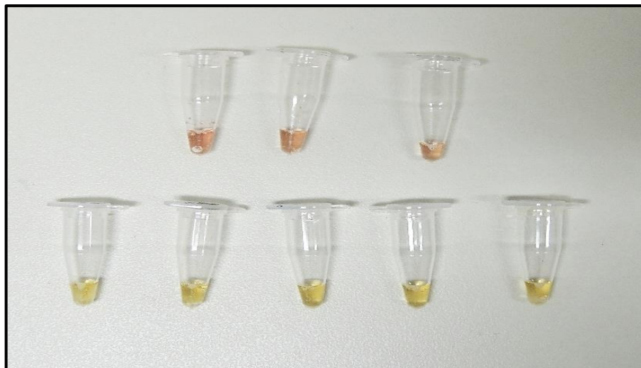
Figura 7. Resultado da reação de LAMP utilizando o WarmStart® Colorimetric LAMP 2X Master Mix. Os tubos negativos apresentam coloração avermelhada. Já os positivos, coloração amarelada.
