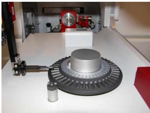
Figura 5 - Auto-amostrador SSA600 utilizado nos atuais espectrômetros para amostragem direta de sólidos desenvolvidos pela Analytik Jena
