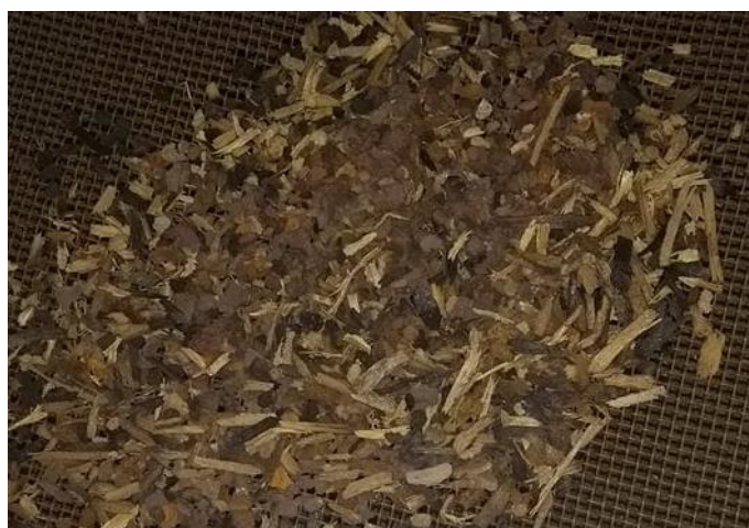
Figura 16 - Material retido na peneira #45
