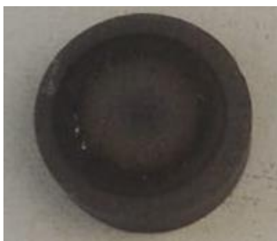
Figura 25 – Resultado de queima para amostra de 40g do lote A – face inferior
