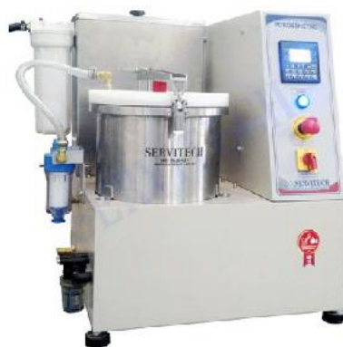
Figura 5 – Porosímetro CT-12174 utilizado para o teste de absorção
