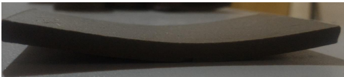
Figura 32 – Peça retangular de 60g em teste de piroplasticidade
