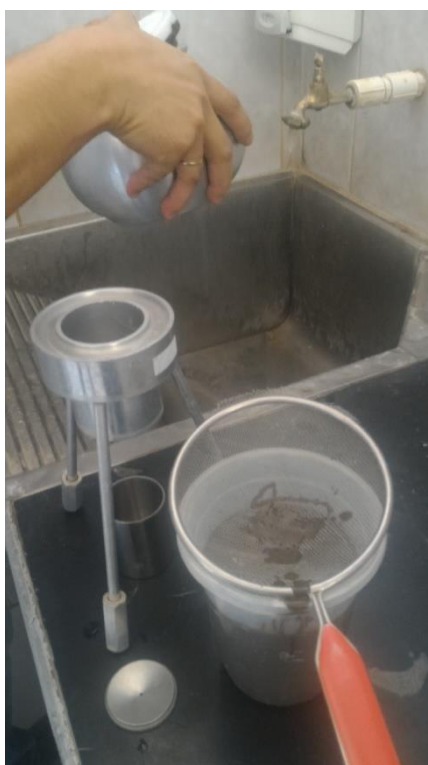
Figura 10 - Viscosímetro copo Ford utilizado para o escoamento das amostras
