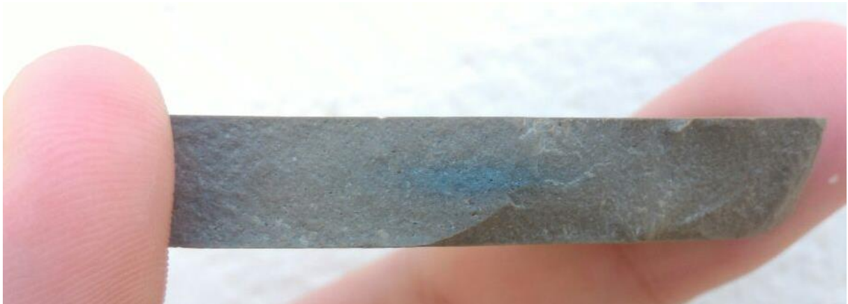
Figura 31 – Amostra da formulação 5%S cisalhada ao meio – 40g
