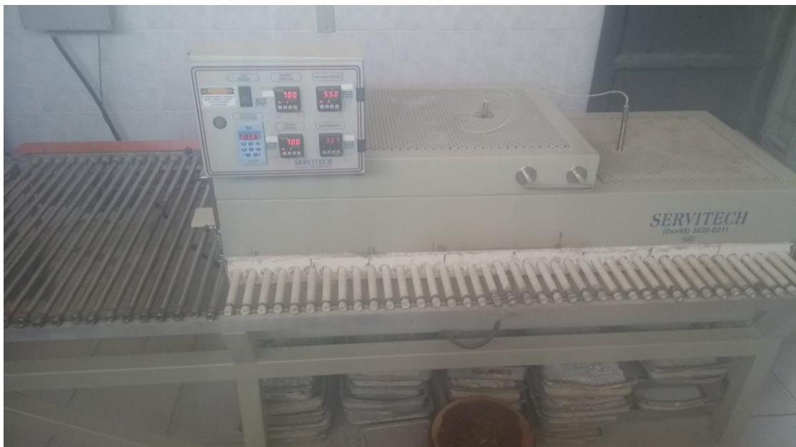
Figura 4 – Forno SERVITECH utilizado para a queima das amostras
