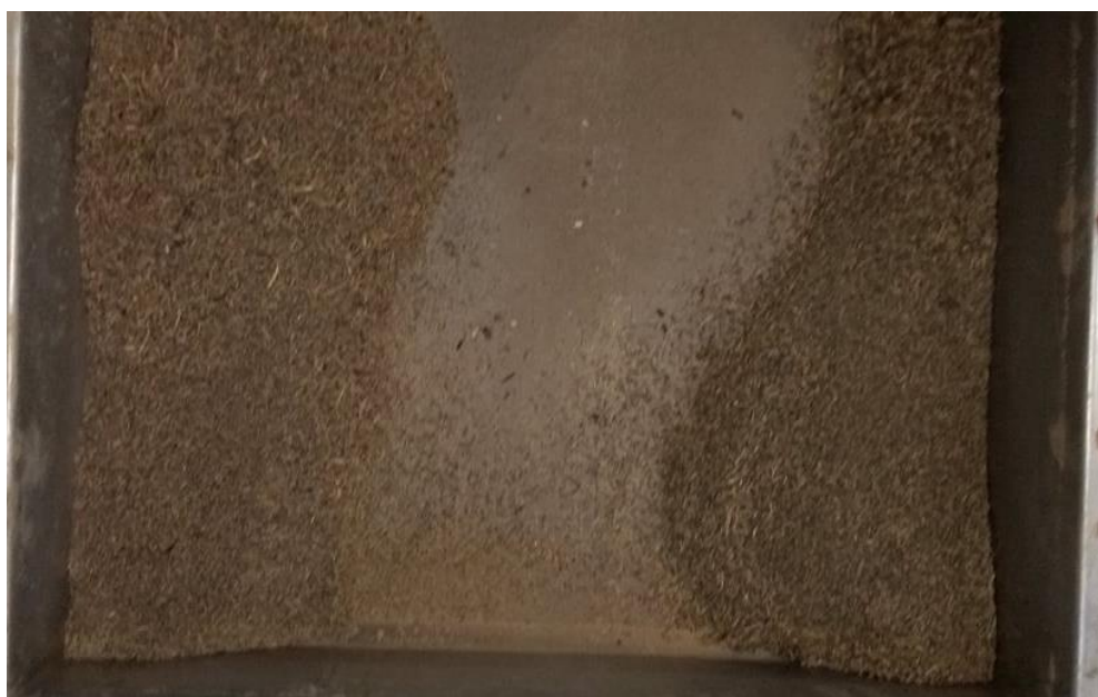
Figura 17 - material retido na peneira #50
