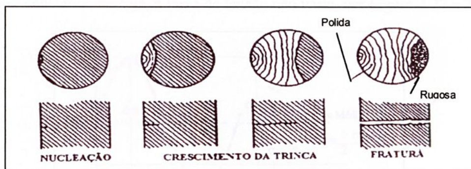
Figura 2.26 - Representação esquemática da superfície que falha por fadiga (SILVA, 1998)
