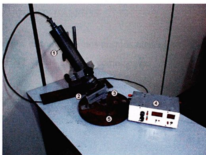
Figura 3.21 – Equipamento Síntese. 1) Fonte de alta tensão. 2) Tubo de raio-x. 3) Colimador. 4) Unidade de controle. 5) Amostra. (TORRES, 2002).
