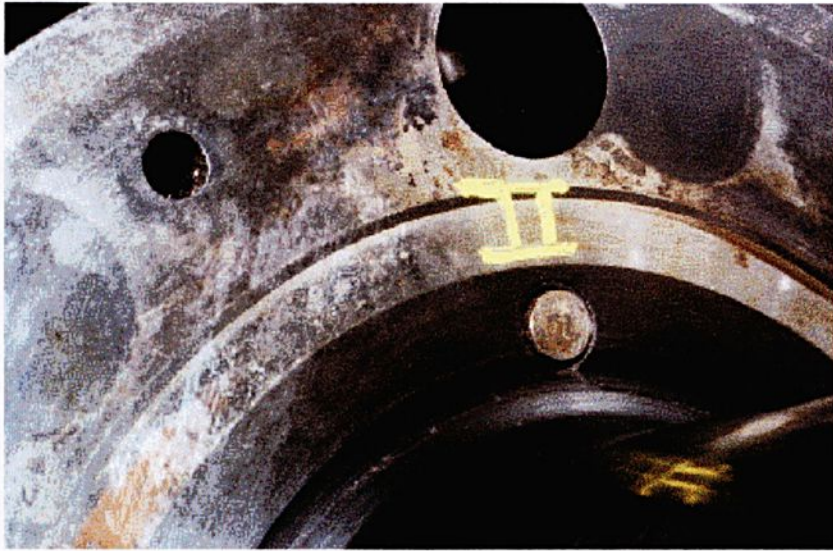
Figura 2.18 - Vista posterior do nariz da árvore trincada
