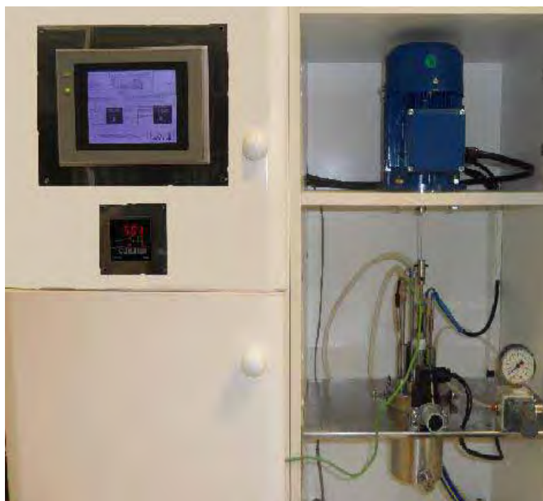
Figura 17 - Aparelho para determinação da resistência térmica.
