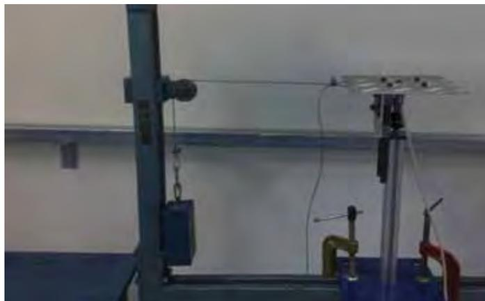
FIGURA 17 - Calibração da célula de carga com a carga aplicada na horizontal
