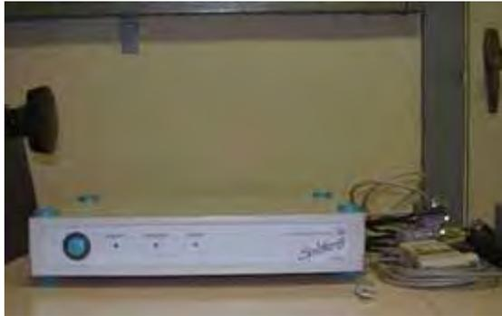
FIGURA 16 - Condicionador de sinais modelo Spider 8 (HBM, Darmstadt, Alemanha)
