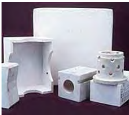
Figura 10- Refratários de mulita com alta estabilidade química e mecânica (MURUGAPPA, 2009).
