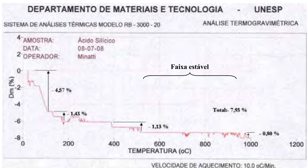
Figura 43 – Análise termogravimétrica do ácido silícico leve.
