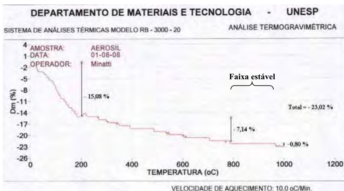
Figura 44 – Análise termogravimétrica do aerosil 380 ® .
