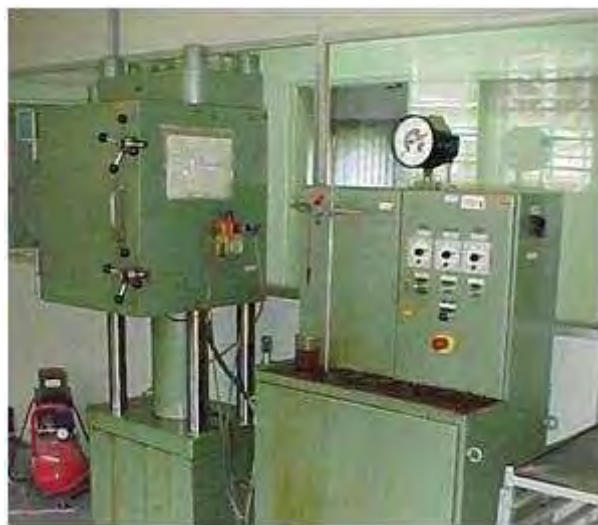
Figura 37 - Prensa isostática AMR – CTA (MARINS, 2008).
