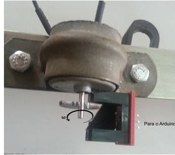
Figura 5.2: Princípio de funcionamento da chave óptica
