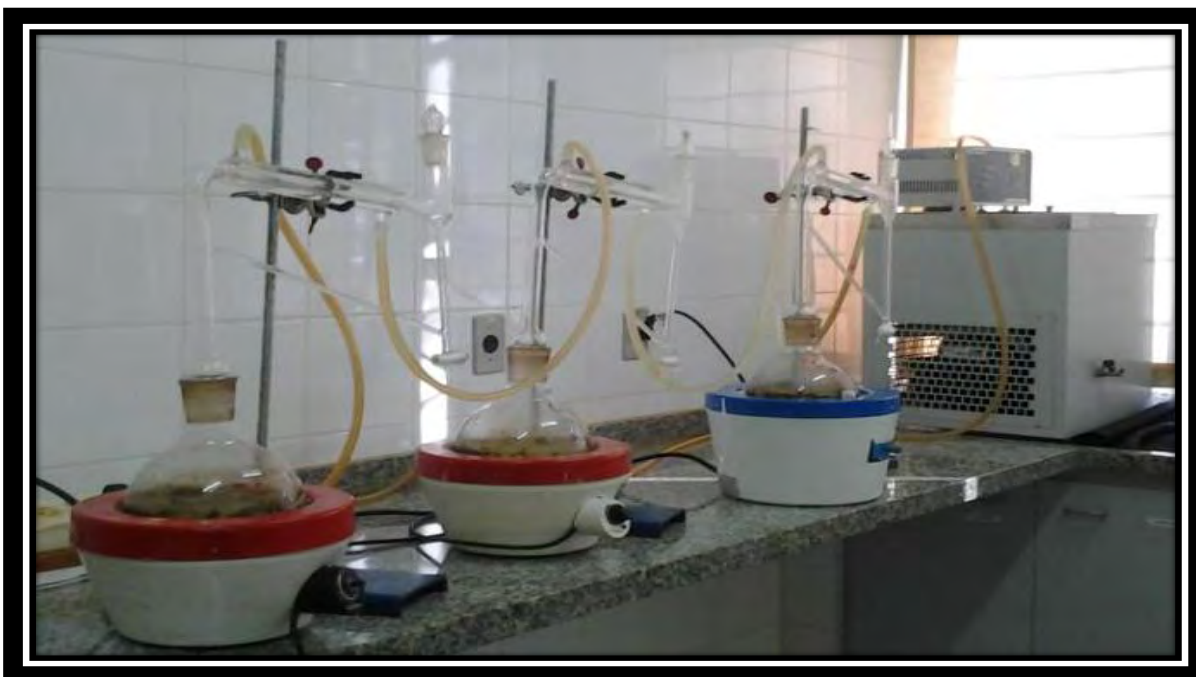
Figura 1: Extração do óleo essencial de jambu por hidro-destilação em aparelho de Clevenger, fonte: Borges, 2012.
