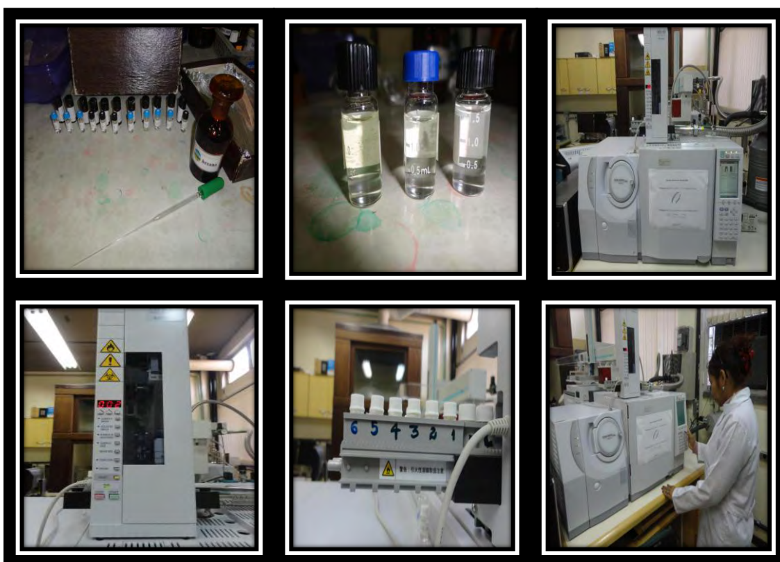
Figura 3: Identificação das substâncias do óleo essencial de jambu em CG/MS.
