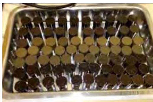
Figura 27. Detalhe das subamostras inseridas em cilindros para a obtenção da densidade aparente e teor de umidade.
