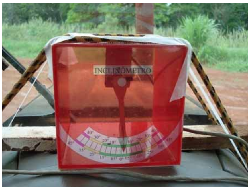
Figura 24 – Inclinômetro desenvolvido para determinação da inclinação lateral do terreno.
