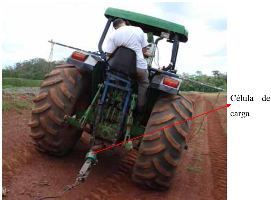
Figura 14 – Célula de carga instalada na barra de tração do trator.
