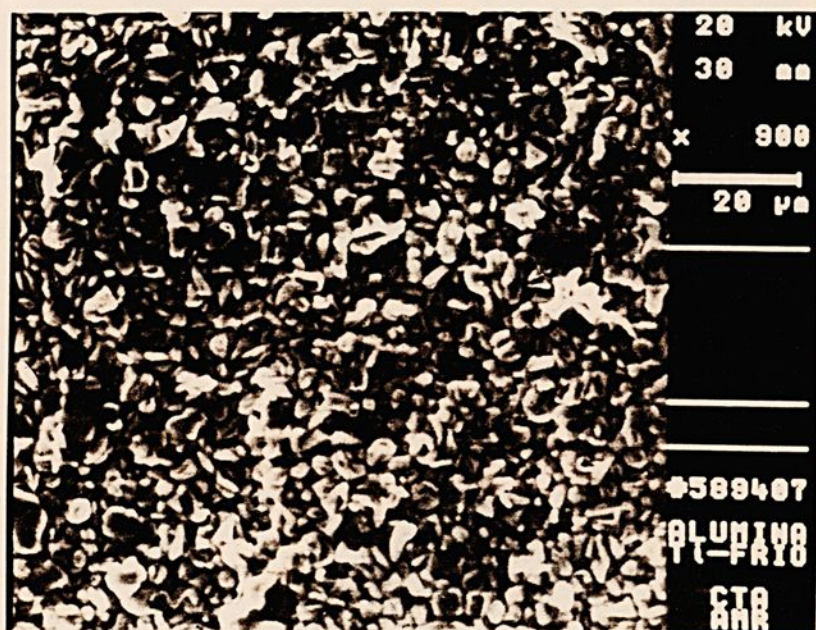
Figura 5.7. Fotomicrografia obtida com MEV, mostrando as características dos grãos no filme de titânio depositado em cerâmica de alumina, sem aquecimento do substrato, ampliação de 900X (tamanho médio de partículas \sim 5 \mu m )(amostra 5)
