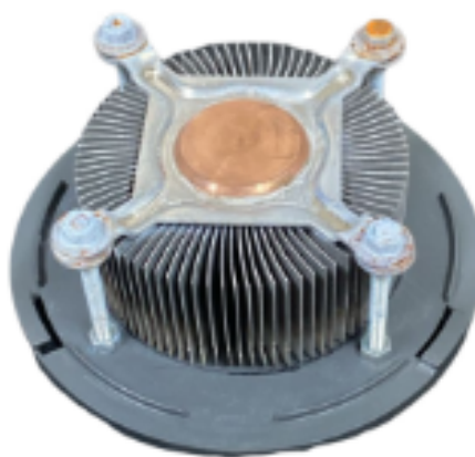
Figura 20: Imagem do cooler de computador utilizado no interior da base da câmara de difusão.
