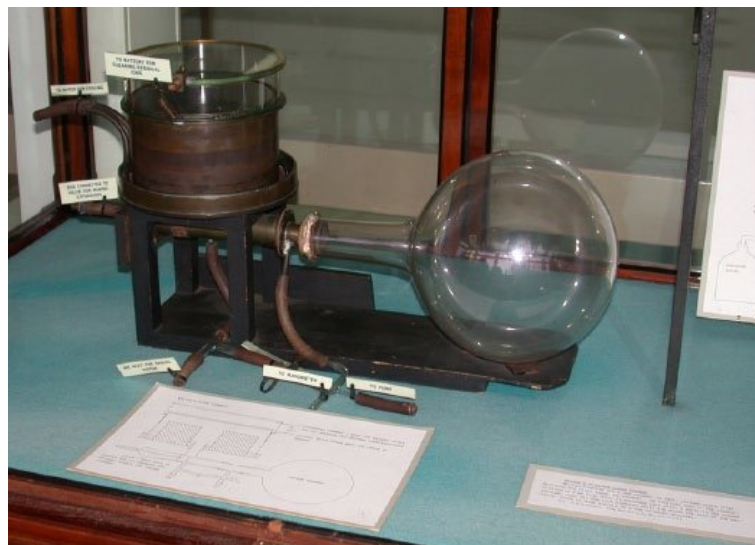
Figura 8: Imagem do aparato experimental de Wilson: a câmara de nuvens. Fonte: [7]
