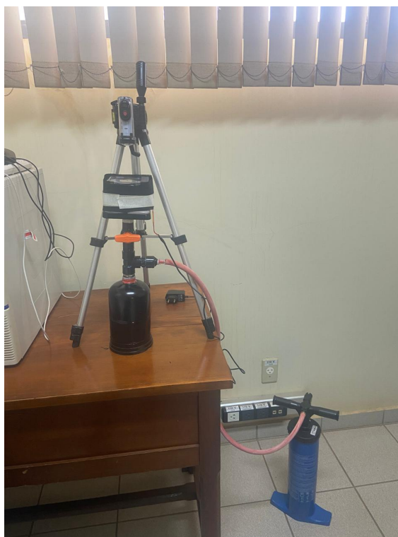
Figura 19: Imagem final da construção da câmara de nuvens.
