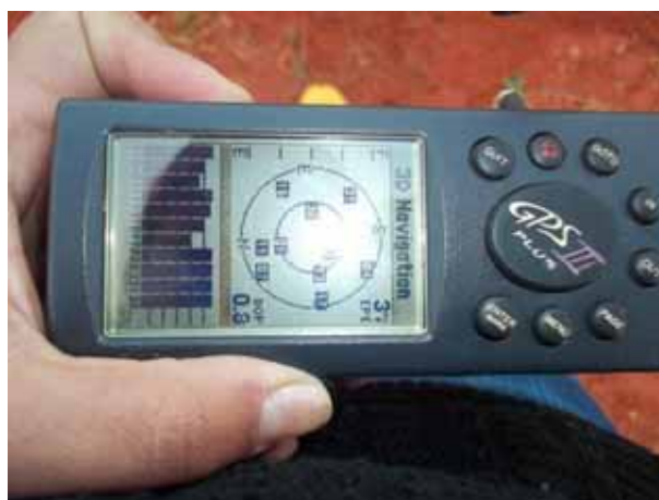
Foto 4.2 – GPS modelo GPS III plus com antena externa da GARMIN Corporation, utilizado na localização das estações magnetométricas.
