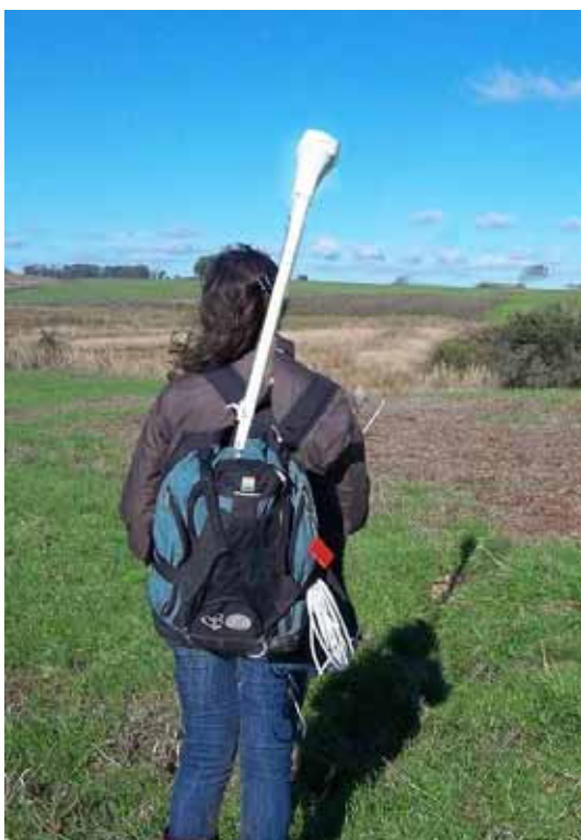
Foto 4.2 – GPS modelo GPS III plus com antena externa da GARMIN Corporation, utilizado na localização das estações magnetométricas.
