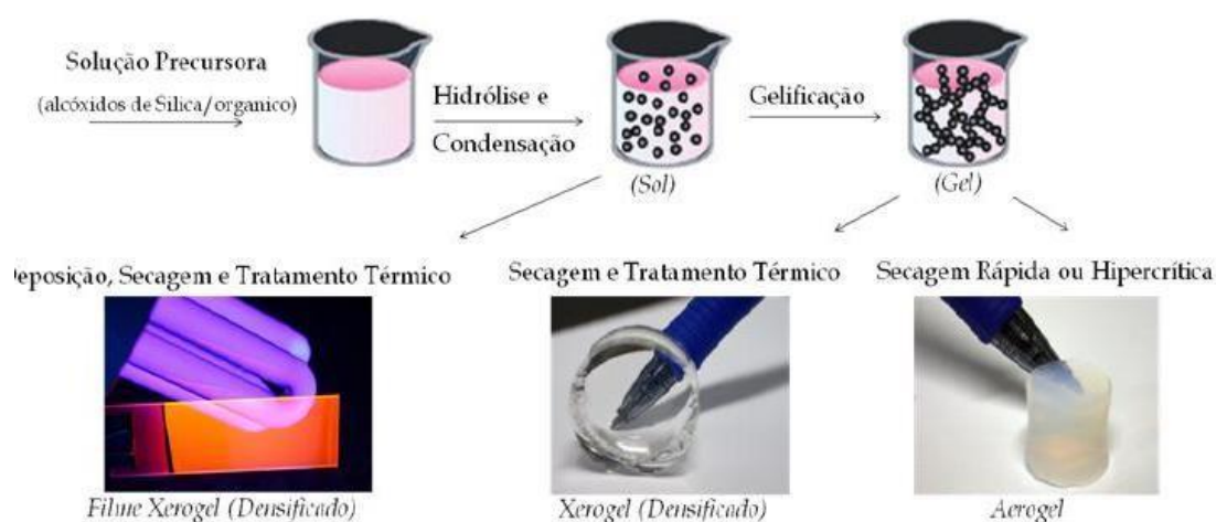
Figura 1 – Diferentes materiais híbridos de sílica/orgânico obtidos via processo sol-gel [10].
