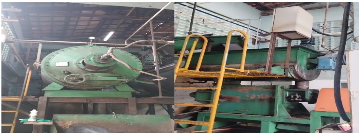
Figura 11 - Digestor a vapor e extrusora de resíduos como carne e osso
