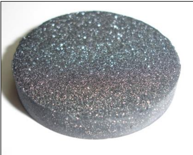
Figura 17: Amostra de SiC após a sinterização a 1950°C por 30 minutos.
