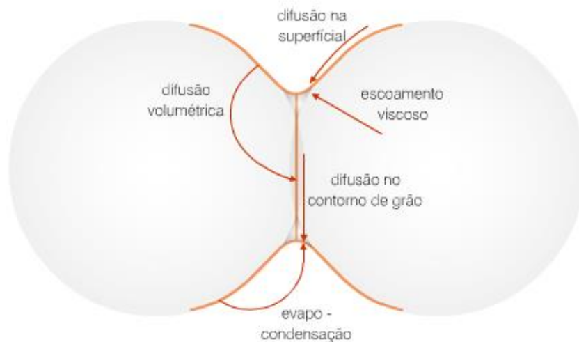
Figura 4: Esquema representativo das alterações na morfologia e tamanho de um grão durante uma sinterização por fase sólida.
