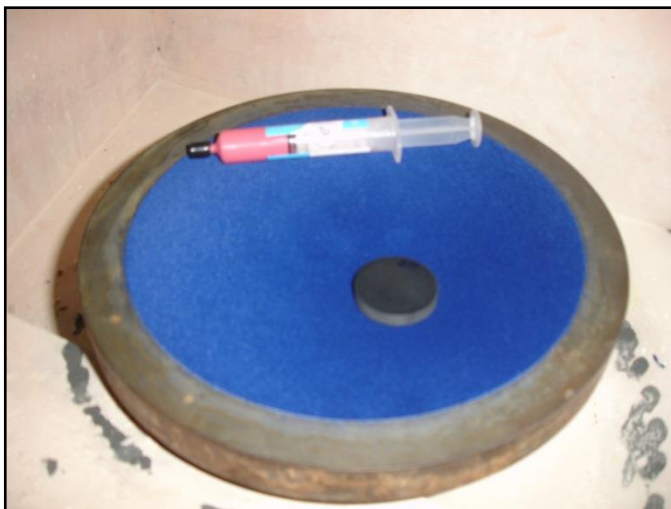
Figura 19: Disco giratório (Feltro), amostra de SiC e pasta de diamante utilizada para polimento.
