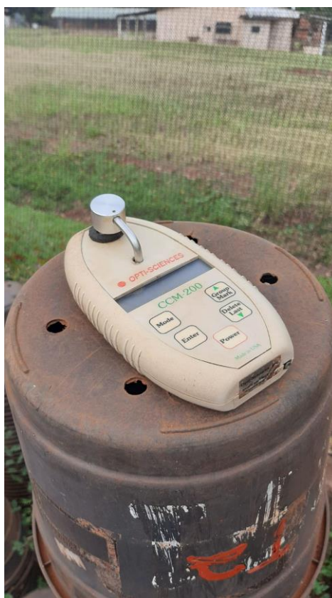
Figura 1. Clorofilômetro Opti-Science®, CCM-200, usado nas determinações do índice de Conteúdo de Clorofila (ICC)
