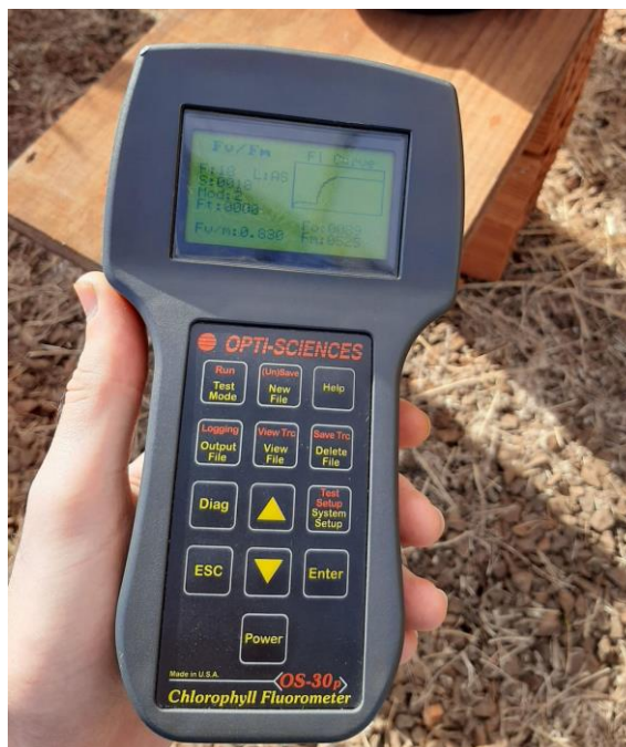
Figura 2. Fluorômetro Opti-Sciences®, Os30P, usado nas determinações das medidas de fluorescência de clorofila.
