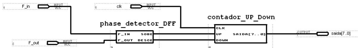
**Figura 6.35.** Detector de Fase e Contador.
