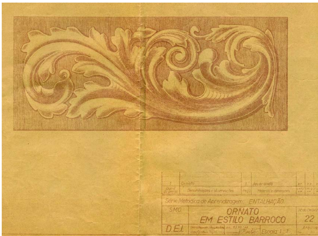
41. Desenho da Série Metódica de Aprendizagem para a Seção de Entalhação, Ornato em estilo barroco, com as especificações de corte e de escala 1:1, 40x30cm, 1944.
