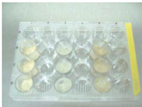
Figura 5 – Volumes iguais dos cimentos testados alocados em poços da placa de 24 poços.
