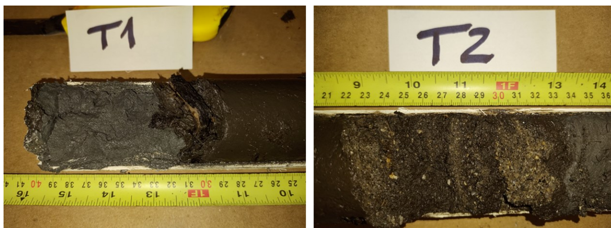
Figura 22 - Detalhe da coloração e horizonte arenoso nos testemunhos de solo do sítio proximal (A) coletados durante a campanha 2.
