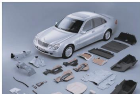
Figura 4 - Ilustração de diversos componentes automotivos reforçados com fibras naturais. Fonte: Mohammed et al. , 2015.
