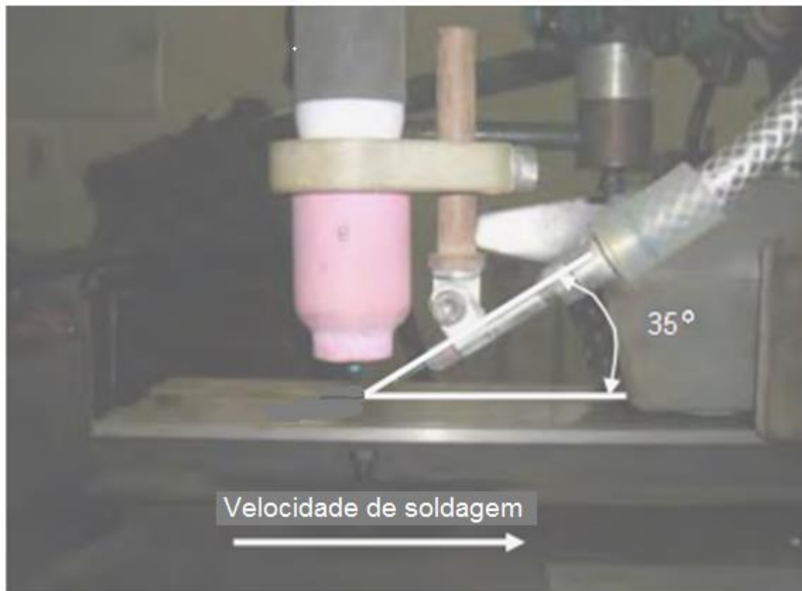
Figura 11 - Tocha de soldagem com bico alimentador de arame.
