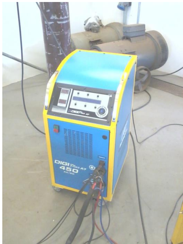
Figura 6 - Fonte de soldagem DIGIPlus A7 fabricada pela IMC-Soldagem.
