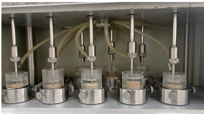
Figura 8 - Cicladora com as 10 amostras posicionadas nos nichos para ensaio de ciclagem mecânica.
