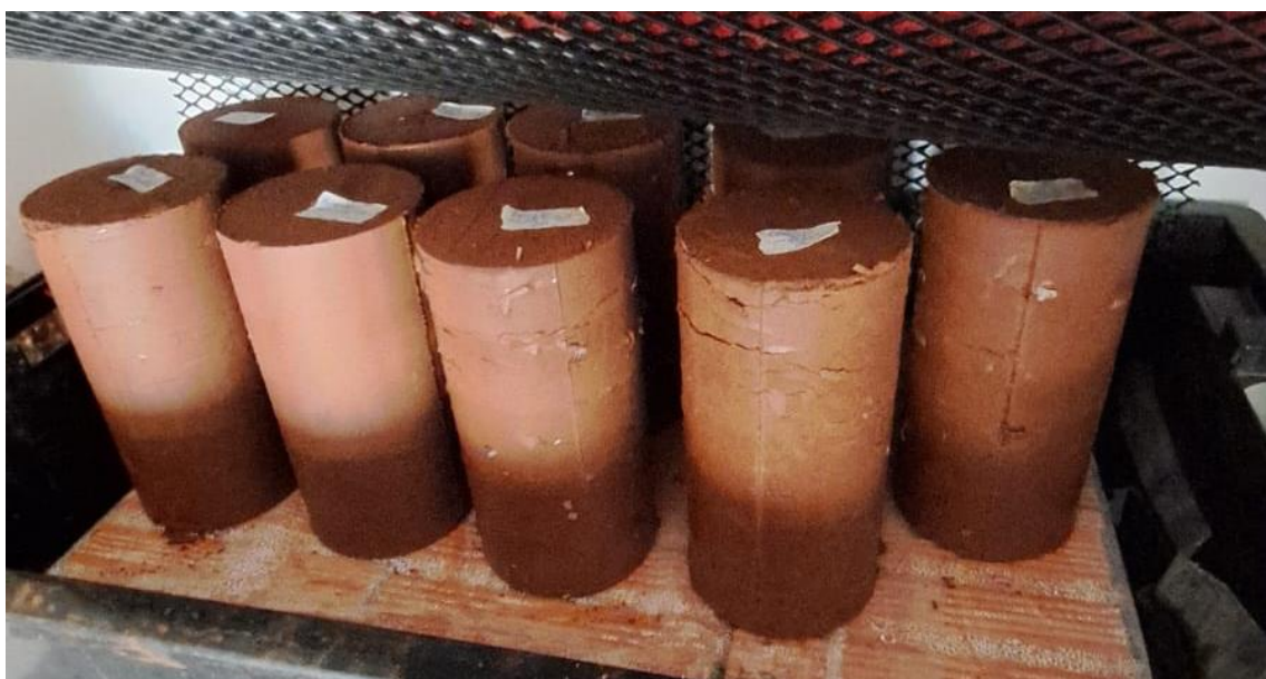
Figura 51 - Corpos de prova em câmara úmida para cura.
