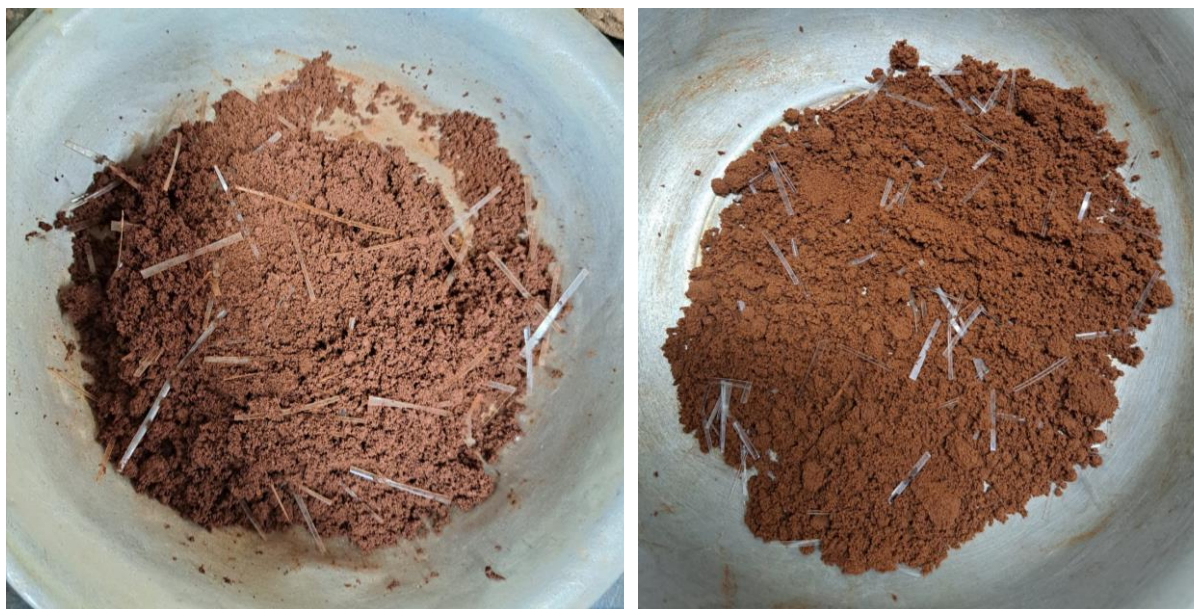
Figura 47 - Mistura solo-tira após homogeneização para areia/argila com tiras PET e PP.
