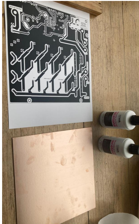
Figura 29 — Layout impresso em papel couché, placa cobreada (não limpa) e removedor de esmalte com acetona para realizar a transferência.
