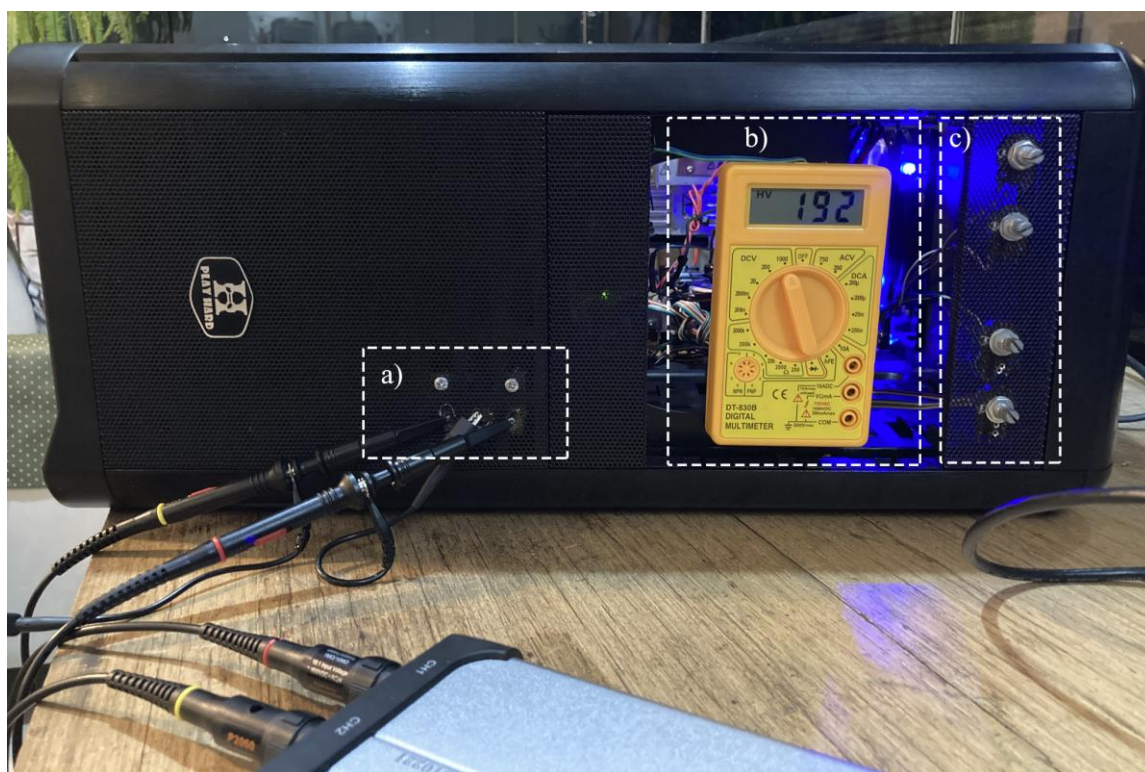
Figura 34 — Visão frontal do gabinete energizado a) Terminais de medição de tensão e corrente com osciloscópio b) Multímetro fixo medindo tensão DC no retificador c) Potenciômetros de controle de largura de pulso e frequência de chaveamento.
