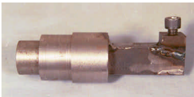
Figura 3.1- Porta ferramenta de fixação utilizado na máquina afiadora universal de ferramentas.
