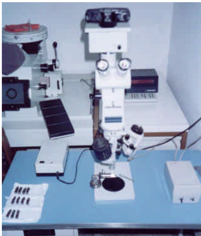
Figura 3.12- Montagem do sistema de verificação de danos na ferramenta de corte.
