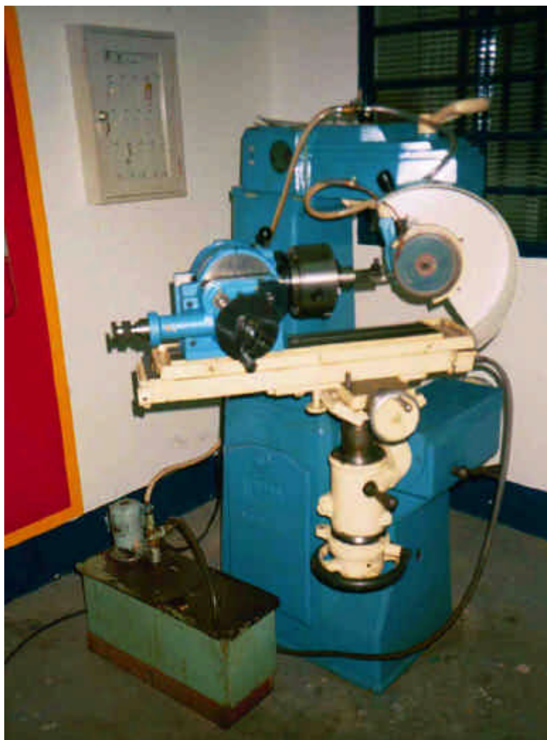
Figura 3.3- Máquina afiadora universal de ferramentas com sistema de fluido refrigerante.
