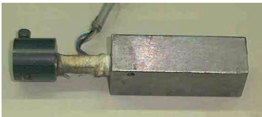
Figura 3.6- Dispositivo empregado para medir a força de corte. (GONÇALVES, 1993)
