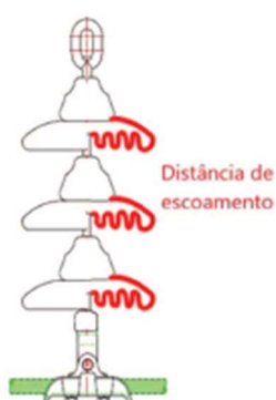
Figura 12 - Ilustração da distância de escoamento de alguns isoladores
