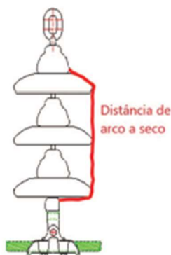
Figura 11 - Ilustração da distância de arco a seco de um conjunto de isoladores
