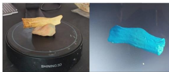
Figura 17 Nuvem de pontos formada a partir do escaneamento do chifre de veado-catingueiro 1. Fonte: Acervo pessoal.
