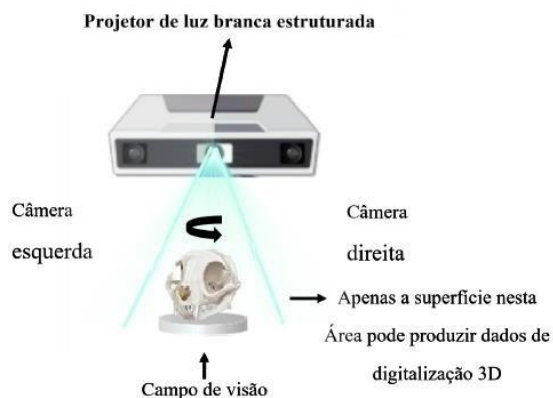
Figura 4 Método de captura de imagem do Scanner EinScan-SE Fonte: Adaptado do manual de equipamento do Scanner.
