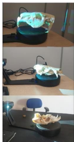
Figura 20 Escaneamento dos crânios de capivara, cateto e lobo-guará. Destaque para o tamanho das peças em comparação a mesa do equipamento. Fonte: Acervo pessoal.
