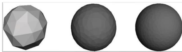
Figura 10 Exemplificação da variação no número de triângulos da malha. Fonte: HUBS, A protolabs company.
