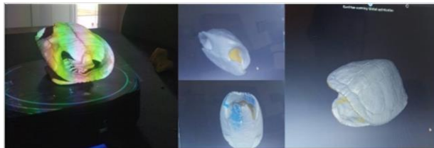
Figura 16 Nuvem de pontos formada a partir do escaneamento da carapaça/plastrão do tigre-d'água. Fonte: Acervo pessoal.
